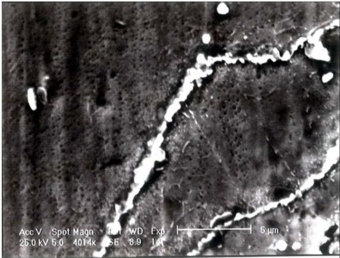
Εικόνα 31. Ρωγμές και Αξιολόγηση (πλαστική παραμόρφωση)
