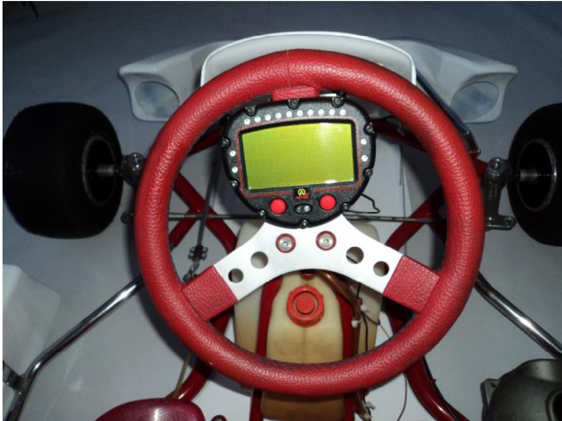
Εικόνα 4.7 Τοποθέτηση του οργάνου στο τιμόνι
