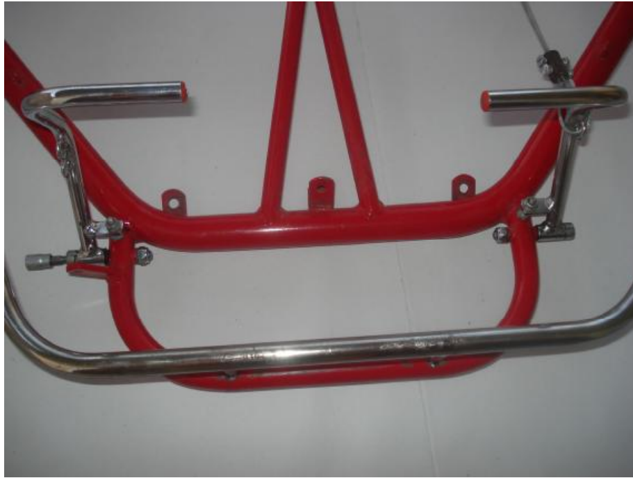
Εικόνα 2.61 Πεντάλ τοποθετημένα εμπρός στο σασί
