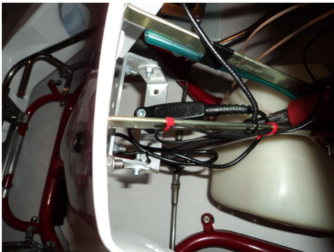
Εικόνα 4.16 Θέση του αισθητήρα δύναμης G στο καρτ
