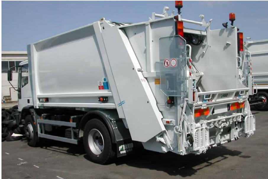
Εικ 3.1 Διαξονικό απορριμματοφόρο όχημα τύπου πρέσσας
