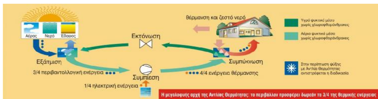
Σχήμα 4-1: Σχηματική αναπαράσταση της αντλίας θερμότητας [πηγή: Sieline]
