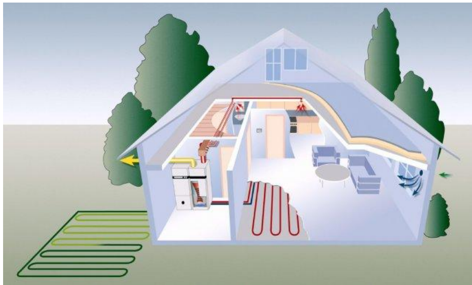
Σχήμα 4-3: Γεωθερμικό σύστημα με οριζόντιους εναλλάκτες
