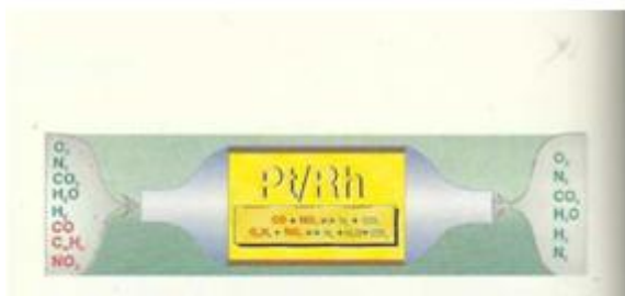
Σχήμα 5.4 αντιδράσεις σε τριοδικό καταλύτη
