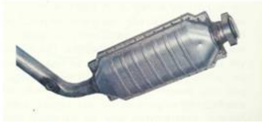
Σχήμα 3.12 ασπίδα θερμότητας με ενισχύσεις
