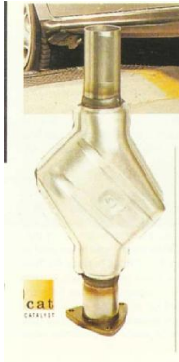
Σχήμα 5.8 Καταλύτης για κινητήρες LPG-CNG.
