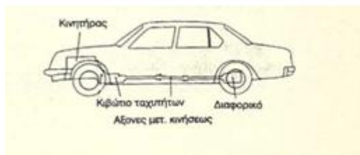
Σχήμα 2 .9 αυτοκίνητο με κινητήρα εμπρός από τον εμπρόσθιο άξονα και κίνηση στους πίσω τροχούς
