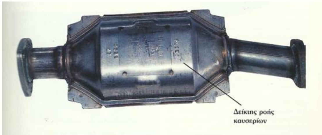
Σχήμα 3.7 δείκτης της ορθής φοράς του μετατροπέα
