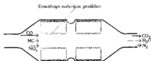
Σχήμα 1.9 μετατροπή των ρύπων σε φιλικότερα αέρια για τον άνθρωπο
