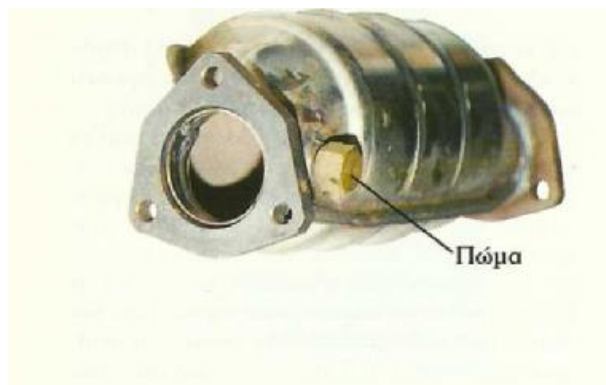
Σχήμα 3.13 Αφαιρούμενο πώμα για τη μέτρηση των ρύπων των καυσαερίων
