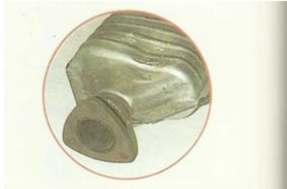
Σχήμα 6.3 εξωτερική ζημιά στο περίβλημα του μετατροπέα
