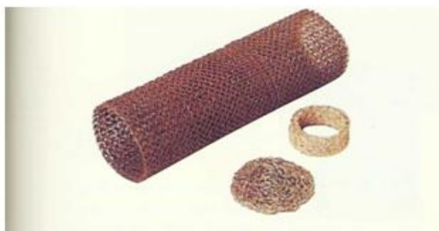
Σχήμα 4.9 μεταλλικά πλέγματα που σχηματίζουν τον φορέα πολύ οικονομικών λύσεων σε μικροκινητήρες
