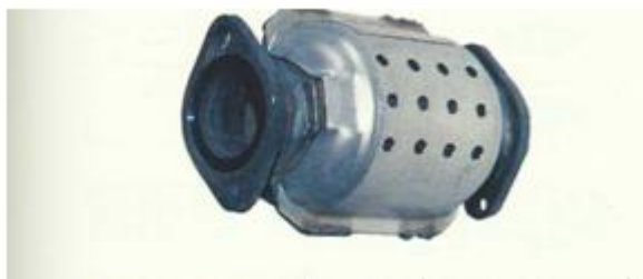
Σχήμα 3.11 ασπίδα θερμότητας εξωτερικά του περιβλήματος του μετατροπέα
