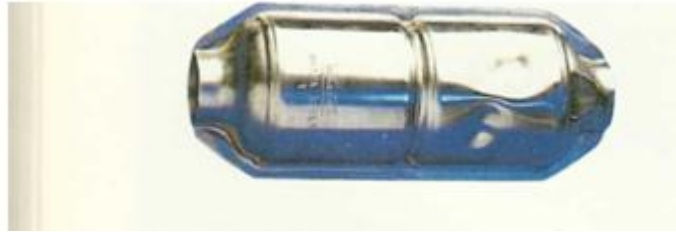
Σχήμα 6.2 εξωτερική ζημιά στο περίβλημα του μετατροπέα που μπορεί να έχει συνέπειες στο εσωτερικό του
