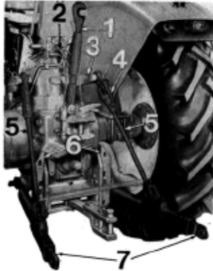
Εικόνα 6: 1) Άνω δεσμός. 2) Χειρομοχλός ρυθμίσεως του μήκους του άνω δεσμού. 3) Βραχίονας ανυψώσεως. 4) Χειρομοχλός ρυθμίσεως του μήκους της αρθρωτής ράβδου ανυψώσεως. 5) Αρθρωτές ράβδοι ανυψώσεως. 6) Μπλοκ ταλαντώσεων. 7) Κάτω δεσμοί.
