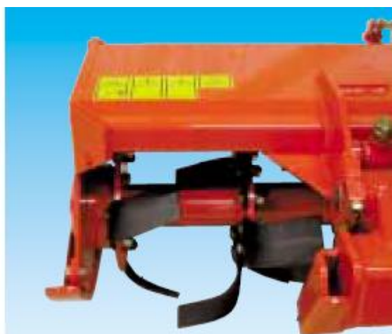
Εικόνα 27: Παχιές πλάκες του πλαισίου εργασίας.
