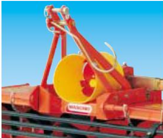
Εικόνα 21: Τρία σημεία σύνδεσης.
