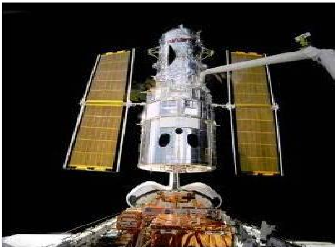
Εικόνα 5: Διαστημικό τηλεσκόπιο της NASA με ηλιακούς συλλέκτες κατασκευασμένους από υλικά με μνήμη σχήματος.
