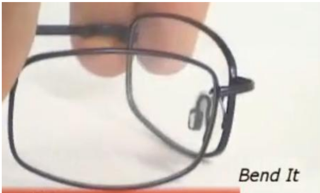
Εικόνα 10: Πλαίσιο γυαλιών νικελίου τιτανίου το οποίο δέχεται καταπόνηση με λυγισμό χωρίς να υπάρχουν πλαστικές παραμορφώσεις.
