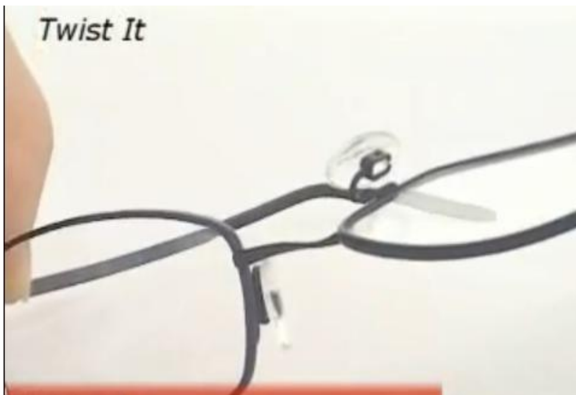
Εικόνα11: Πλαίσιο γυαλιών νικελίου τιτανίου το οποίο δέχεται καταπόνηση με στρέψη χωρίς να υπάρχουν πλαστικές παραμορφώσεις.
