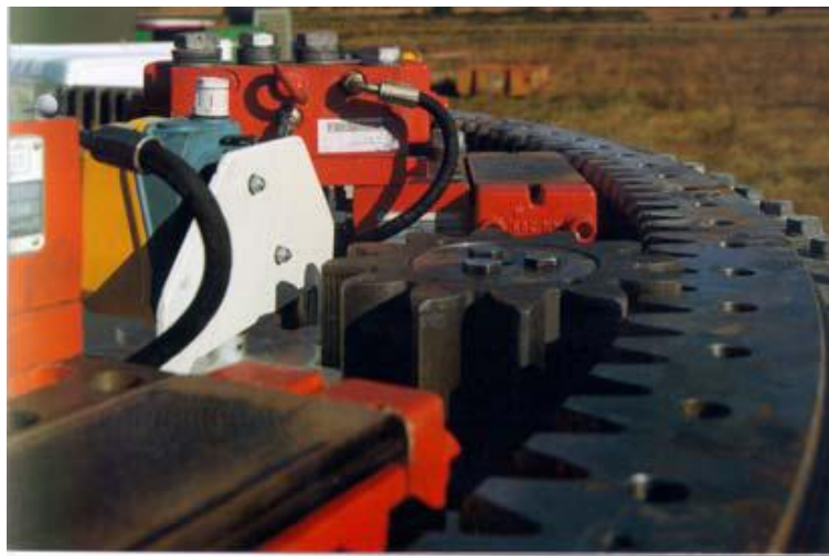
Σχήμα 2-5: Σύστημα προσανατολισμού (yaw drive).
