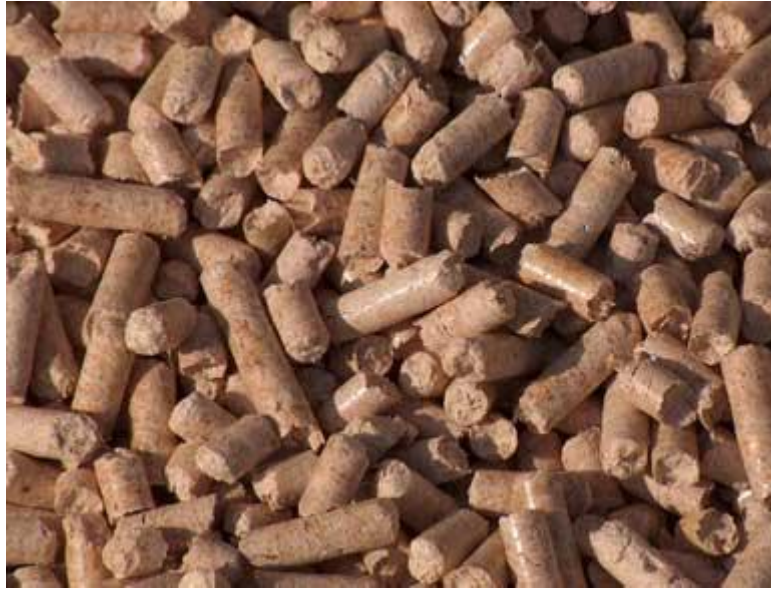
Σχήμα 1-8: Μια μορφή βιομάζας (pellets/ συσσωματώματα) τα οποία προκύπτουν από τη μηχανική συμπίεση οργανικών υλών.
