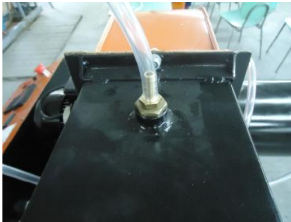
Εικόνα 2.4: Σημείο τοποθέτησης σωλήνα μανομέτρου στον αγωγό κατάθλιψης
