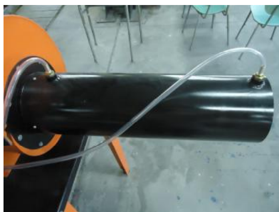
Εικόνα 2.7: Σημείο τοποθέτησης σωλήνα μανομέτρου στον αγωγό αναρρόφησης
