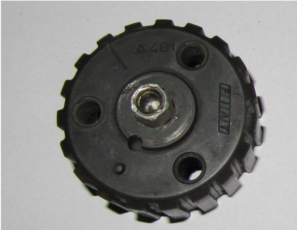
Εικόνα 30 - Μικρή τροχαλία πριν τη τοποθέτησή της
