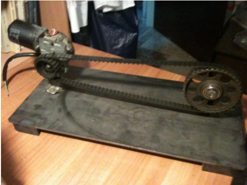
Εικόνα 11 - Συσκευή ιμαντοκίνησης για εργαστηριακούς σκοπούς
