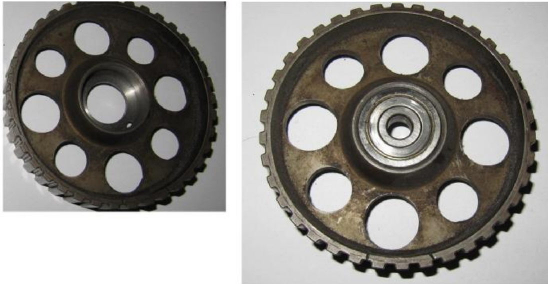
Εικόνα 32 - Μεγάλη τροχαλία πριν και μετά την τοποθέτηση του ρουλεμάν
