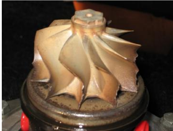
Εικόνα 4.5.4: στρόβιλος με κατεστραμμένα πτερύγια
