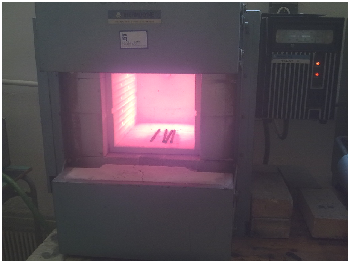
Εικόνα 5.34: Εξαγωγή των δοκιμών από το φούρνο
