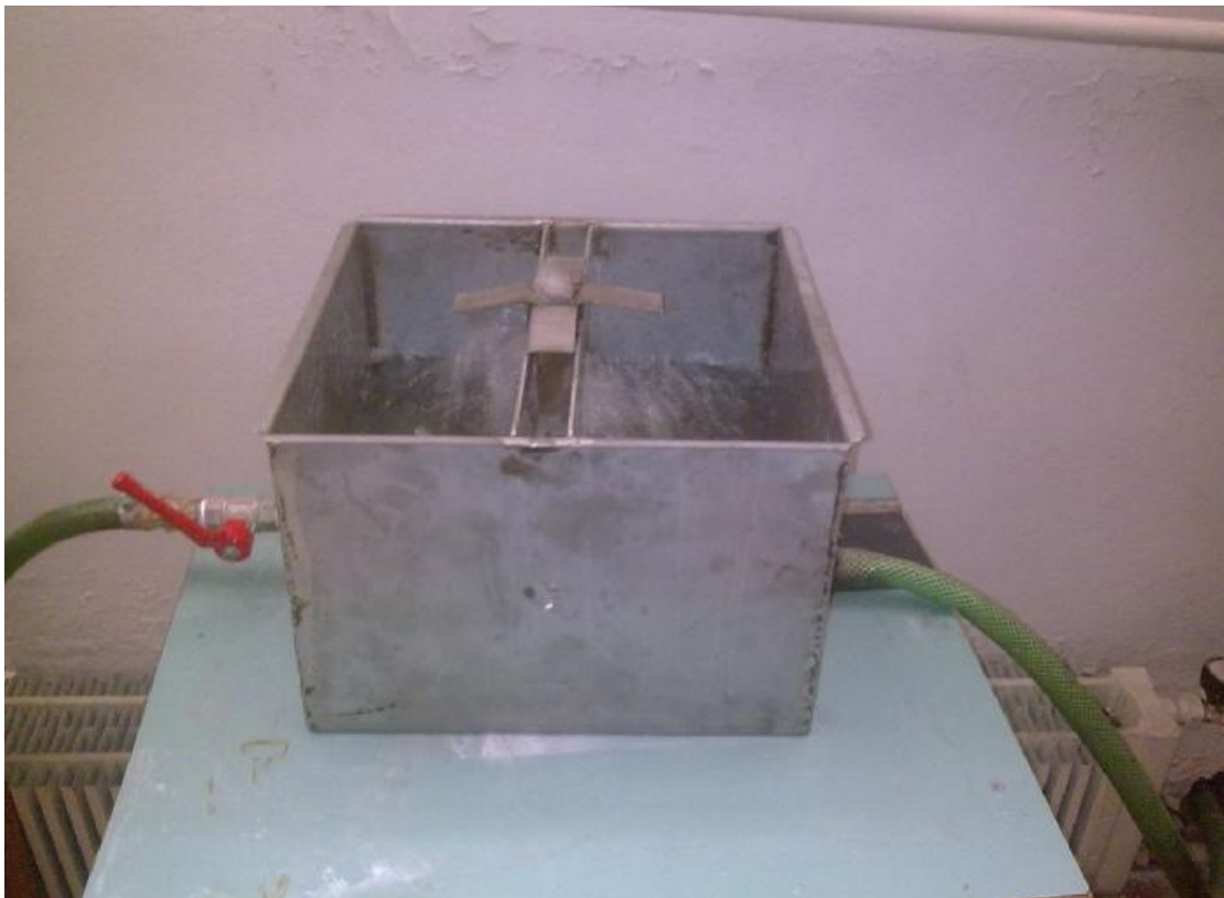
Εικόνα 5.35: Συσκευή εμβάπτισης των δοκιμών στο νερό
