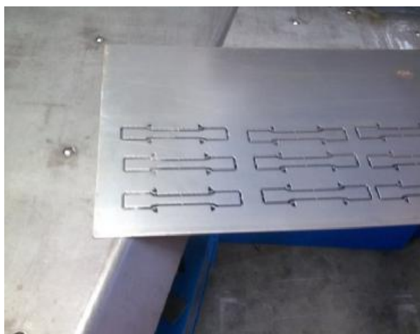
Σχήμα 5.2: Κατασκευή πρισματικών δοκιμίων σε εργαλειομηχανή C.N.C.
