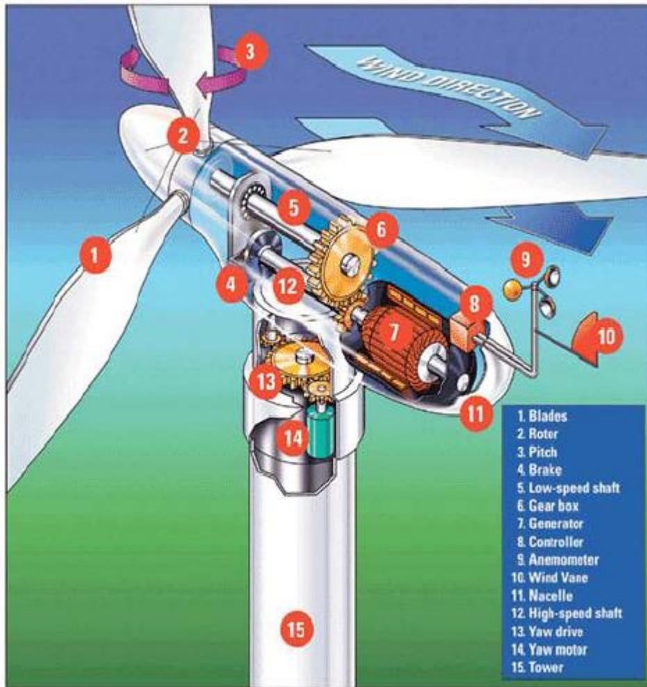
Σχήμα 1.20: Μέρη ανεμογεννήτριας οριζόντιου τύπου
