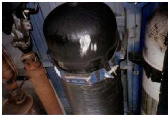
Κύλινδρο αποθήκευσης μετά από ατύχημα
