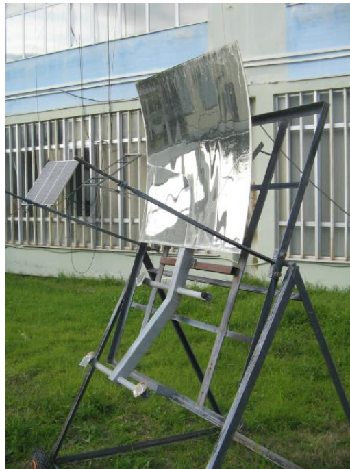
Εικόνα 2.1 Παραβολικό κάτοπτρο το οποίο χρησιμοποιήθηκε σε προκαταρκτικές μετρήσεις
