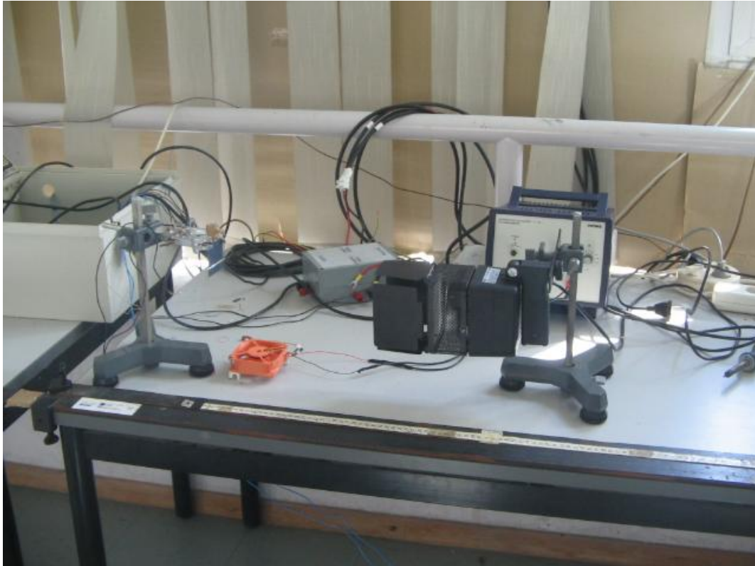
Εικόνα 2.2 Πειραματική διάταξη διερεύνησης της ενεργειακής συμπεριφοράς φωτοβολταϊκού υπό συνθήκες αυξημένης ακτινοβολίας
