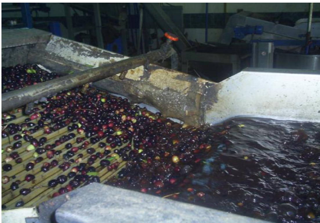
Εικόνα 3.4: Πλυντήριο καθαρισμού ελαιόκαρπων
