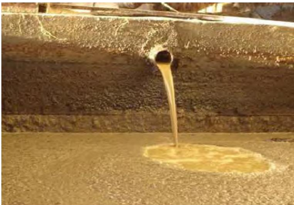
Εικόνα 5.13: Διαχείριση των υγρών αποβλήτων ελαιοτριβείων σε δεξαμενές καθίζησης
