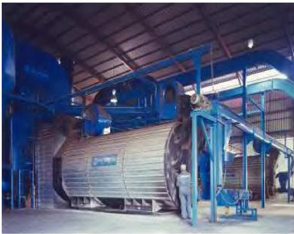
Εικόνα 5.19: Ξηραντήρας περιστρεφόμενου τυμπάνου
