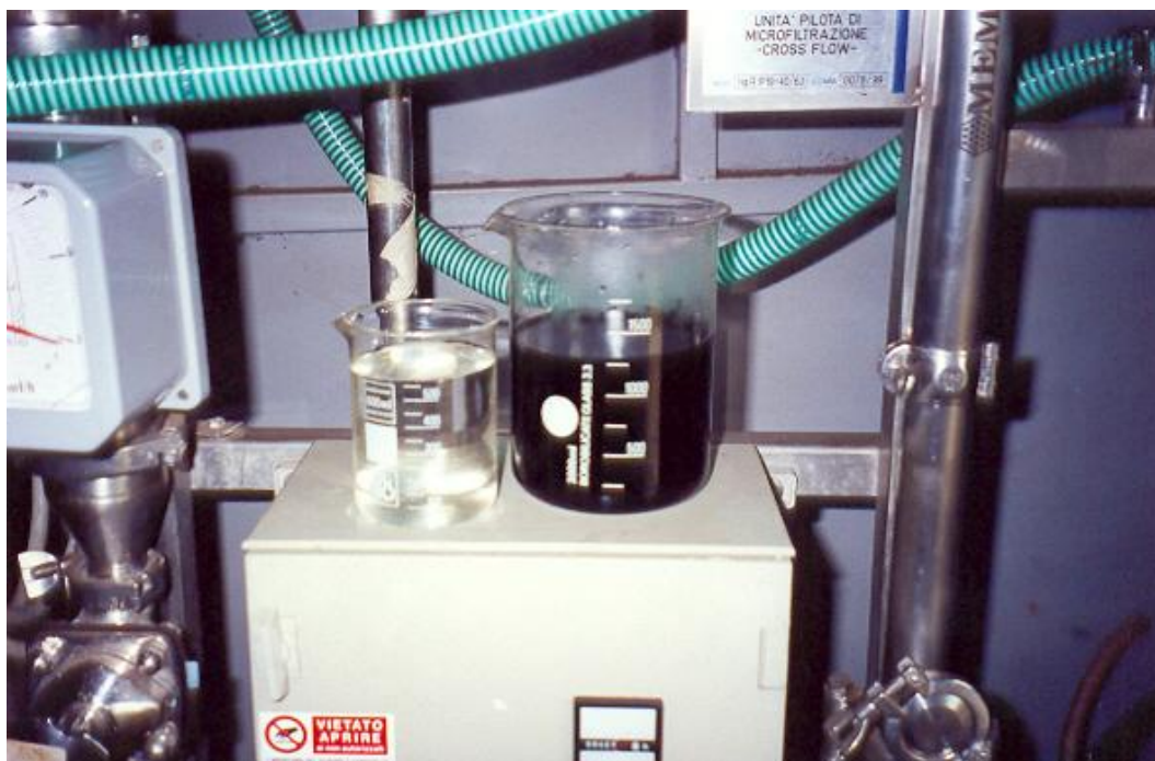
Εικόνα 5.17: Δείγμα πριν την εισαγωγή στην μονάδα αντίστροφης όσμωσης (δεξιά) και μετά την επεξεργασία (αριστερά)
