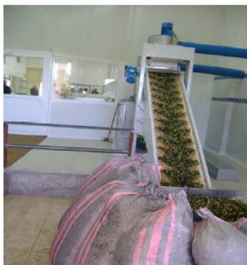
Εικόνα 3.1: Χοάνη παραλαβής και ταινία μεταφοράς του ελαιοκάρπου
