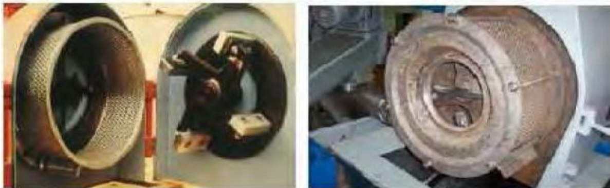
Εικόνα 3.4: Διατάξεις που χρησιμοποιούνται για την σύνθλιψη του ελαιοκάρπου στα σύγχρονα ελαιοτριβεία
