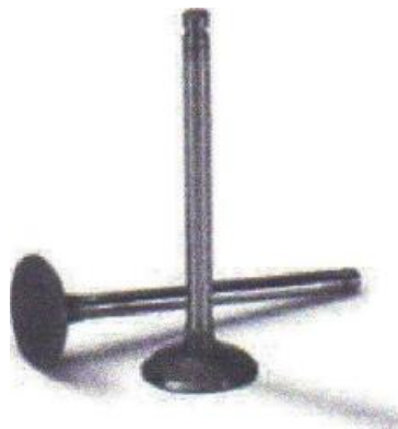
Σχήμα 2.8: Βαλβίδες εισαγωγής και εξαγωγής.
