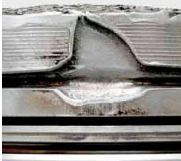
Σχήμα 4.17: Έμβολο με κατεστραμμένη περιοχή ελατηρίων.
