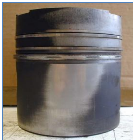
Σχήμα 4.4: Έμβολο περιφερειακά φθαρμένο.
