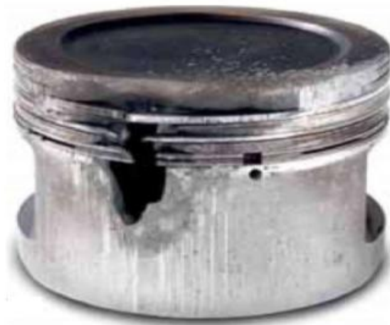
Σχήμα 4.10: Έμβολο με θραύση στην περιοχή των ελατηρίων.
