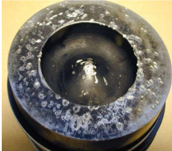
Σχήμα 4.8 : Έμβολο με κοιλώματα και οδόντωση.
