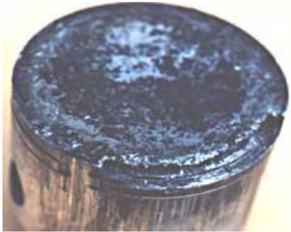
Σχήμα 4.13: Πυρωμένο πρόσωπο εμβόλου.
