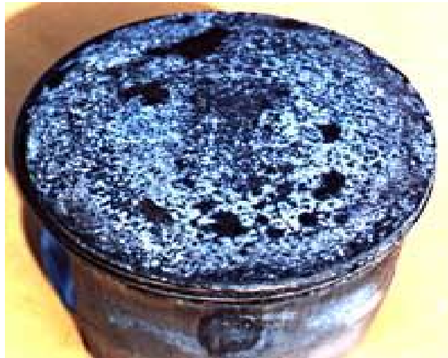
Σχήμα 4.16: Έμβολο με σφηνωμένα τα ελατήρια.
