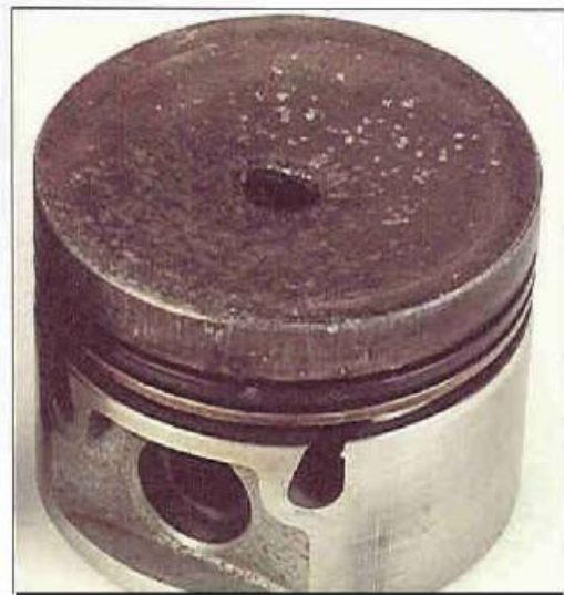
Σχήμα 4.7: Έμβολο με οπή στο πρόσωπο.
