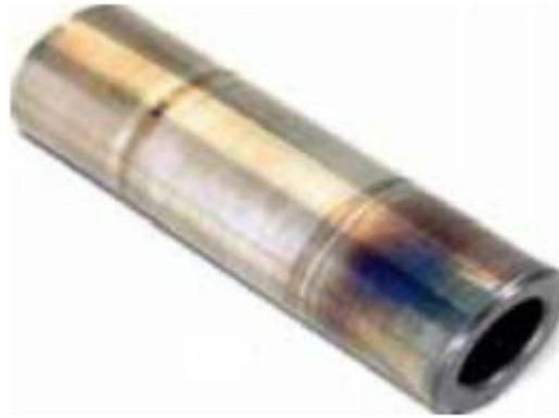
Σχήμα 4.5: Κολημένος πείρος περιστροφής.
