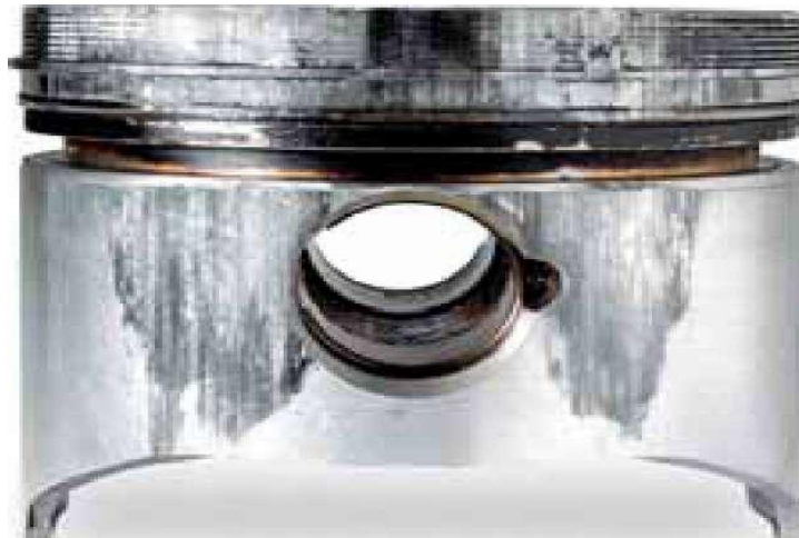
Σχήμα 4.11: Διαβρωμένο έμβολο στην περιοχή του πείρου.
