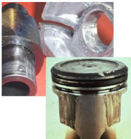
Σχήμα 4.6: Φθαρμένος πείρος διωστήρα και οι επιπτώσεις του στο έμβολο
