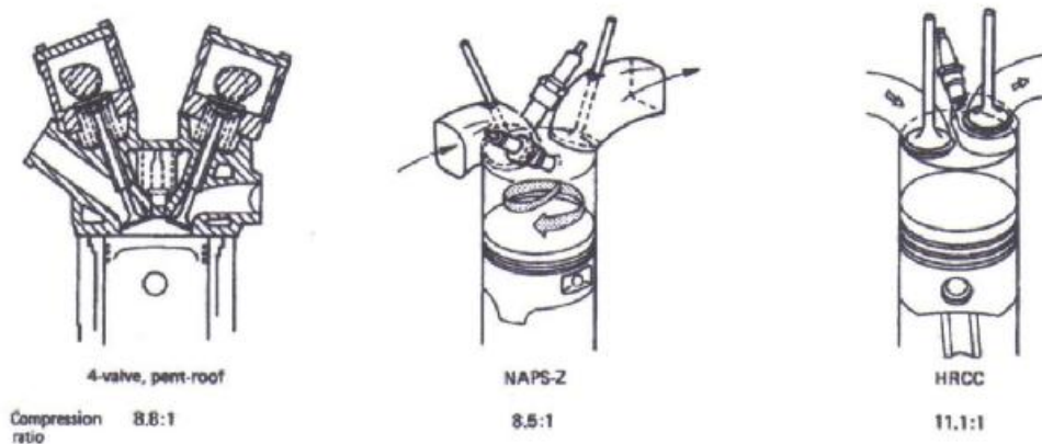
Σχήμα 3.7: Τρεις αποδοτικοί τύποι θαλάμων καύσης.
