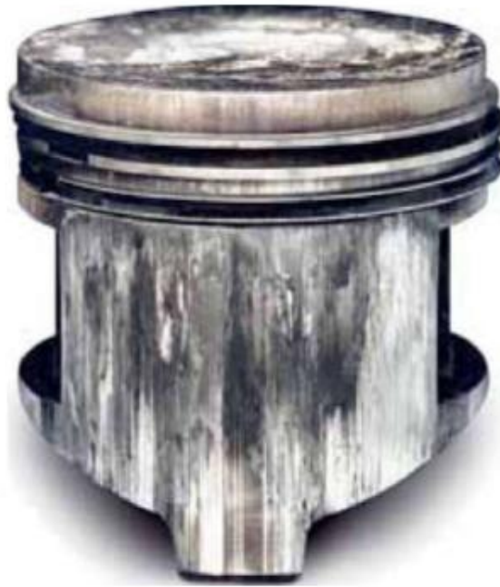
Σχήμα 4.14: Έμβολο με αμυχές στην περιφέρειά του.
