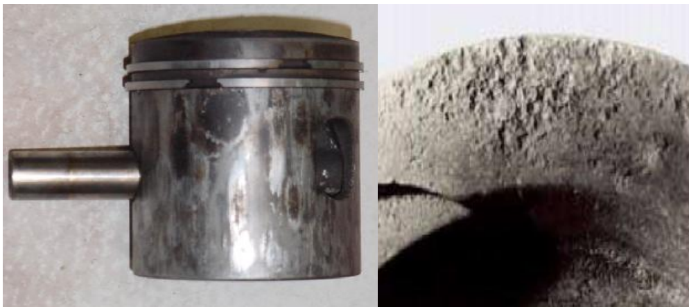
Σχήμα 4.15: Αμυχές στην περιφέρεια του εμβόλου και ιδιαίτερα στη περιοχή του πείρου.
