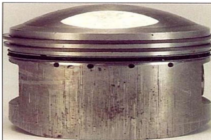
Σχήμα 4.9: Φθαρμένο πιστόνι λόγω ύπαρξης μικροσωματιδίων
