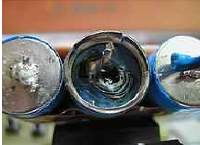
Εικόνα 5.2: Καταστροφή μπαταρίας από υπερφόρτωση
