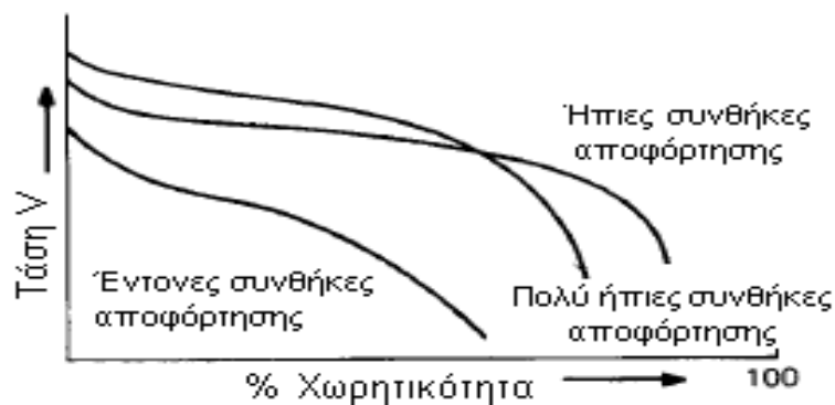
Σχήμα 2.9: Αποφόρτιση μιας μπαταρίας σε διαφορετικές συνθήκες αποφόρτισης
