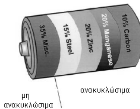
Σχ. 6.1: Γενική εικόνα ανακυκλώσιμων υλικών σε μια μπαταρία
