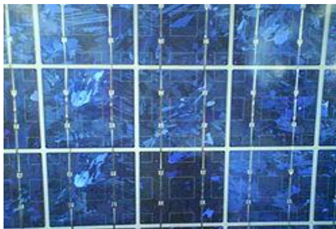
Εικόνα 3.6: Φωτοβολταικά από πολυκρυσταλλικό πυρίτιο
