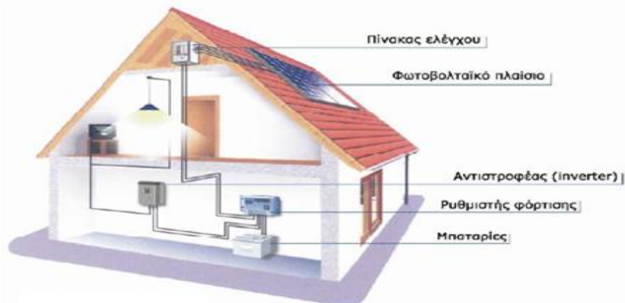
Εικόνα 4.3: Μέρη αυτόνομου Φ/Β συστήματος σε οικία
