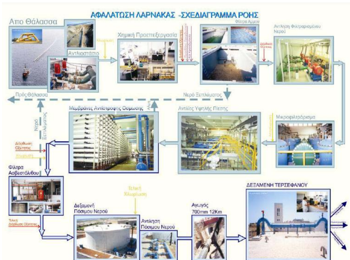
Σχήμα 4.6: Σχεδιάγραμμα ροής μονάδας αφαλάτωσης Λάρνακας, πηγή :
