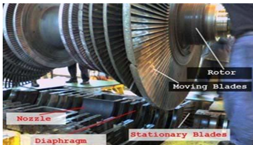
Σχήμα 2.4: Πλάγια όψη αμοστροβίλου με τα βασικά του μέρη.
