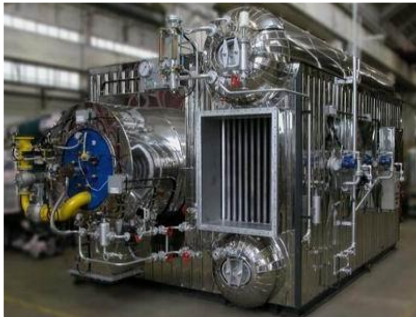
Σχήμα 2.1: Εξωτερική όψη βιομηχανικού ατμολέβητα.
