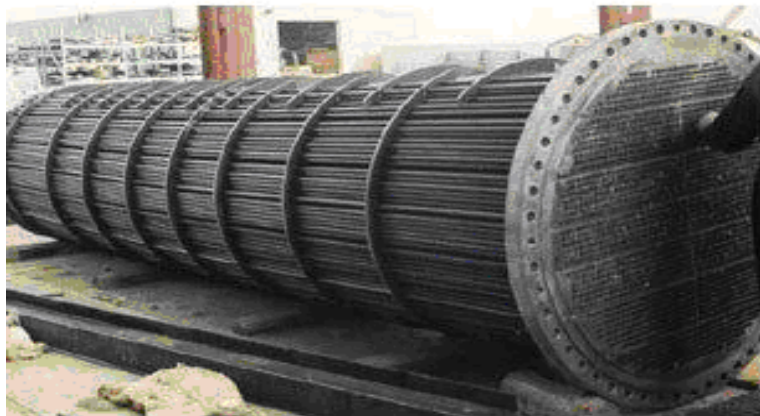
Σχήμα 3.6: Δέσμη σωλήνων (αυλοί) εναλλάκτη.
