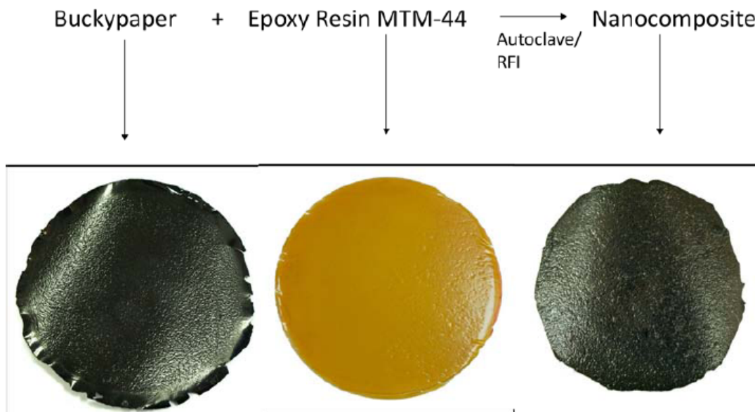
Σχήμα 1. 4: Τυπικές φωτογραφίες μεμβράνης νανοσωλήνων άνθρακα πολλαπλού τοιχείου (αριστερά), σκέτης εποξειδικής ρητίνης (μέση) και νανοσυνθέτου (δεξιά)
