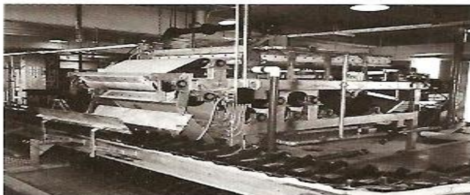
Εικόνα 19 : Αφυδάτωση με ταινιοφιλτράτρεσσα : (α) τρία βασικά στάδια αφυδάτωσης, (β) εικόνα μιας τυπικής εγκατάστασης
