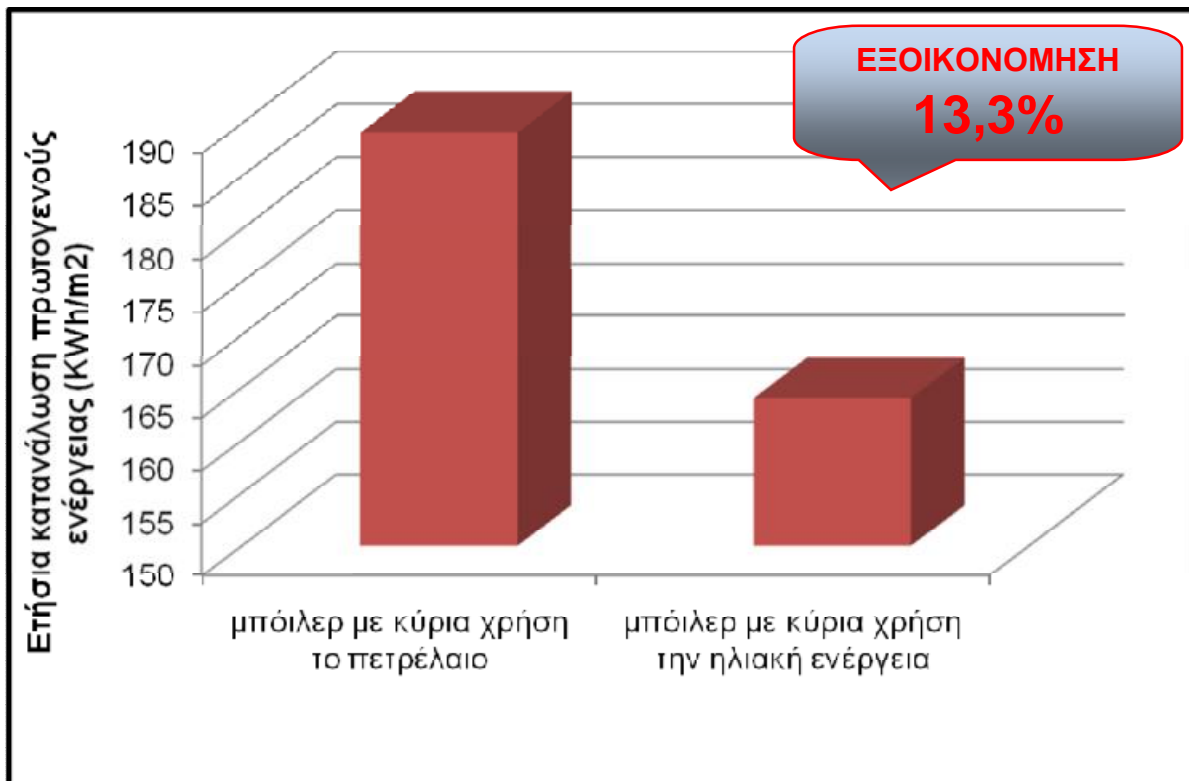
Εικόνα 5.7: Κατανάλωση πρωτογενούς ενέργειας πριν και μετά την αντικατάσταση μπόιλερ
