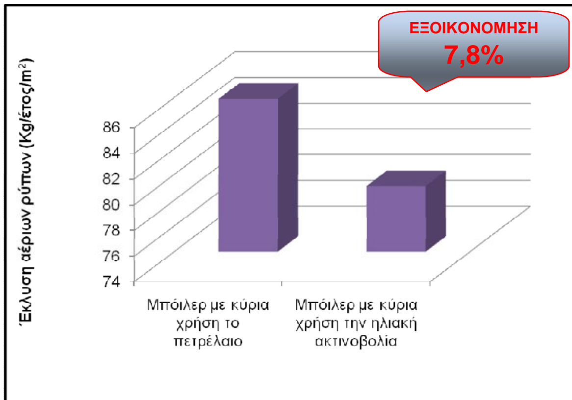
Εικόνα 5.8: Έκλυση αέριων ρύπων πριν και μετά την αντικατάσταση μπόιλερ
