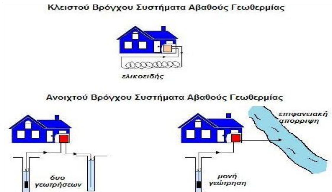
Εικόνα 3.63: Είδη γεωθερμικών συστημάτων Πηγή: GEOTHERMAL (Εθνικό Μετσόβιο Πολυτεχνείο Σχολή Μηχανικών Μεταλλείων- Μεταλλουργών)
