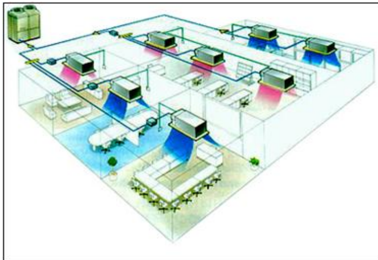
Εικόνα 3.31: Σύστημα κεντρικού κλιματισμού Πηγή: ENFORCE (Energy Auditor Network)
