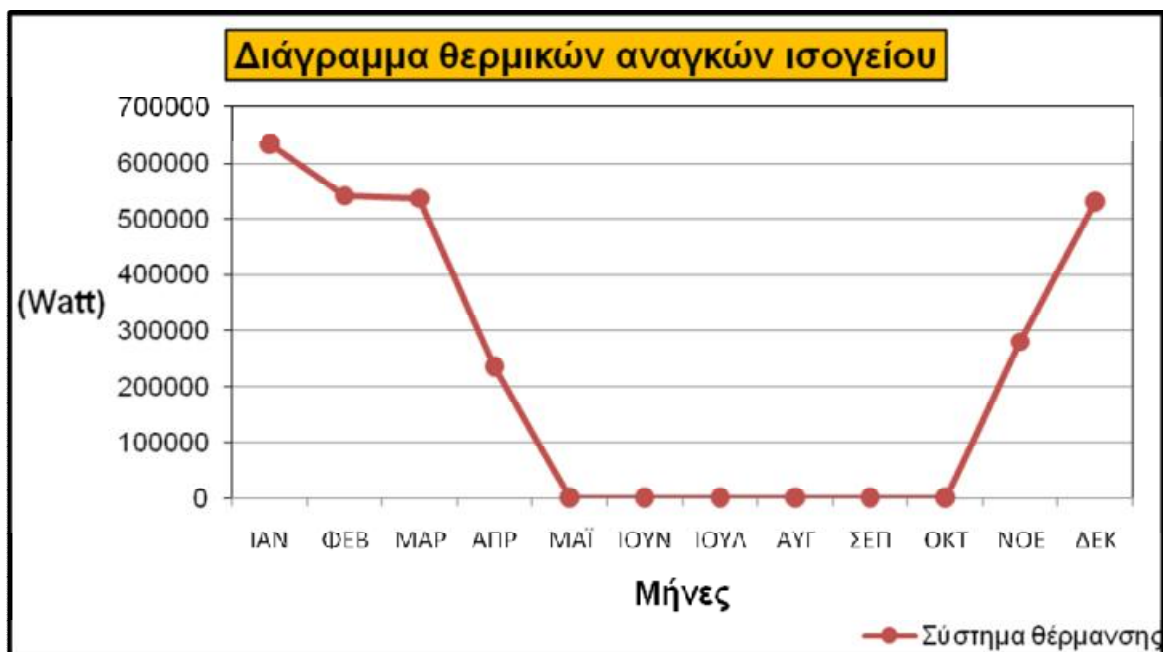
Εικόνα 4.25: Διάγραμμα θερμικών αναγκών ισογείου κτιρίου αναφοράς
