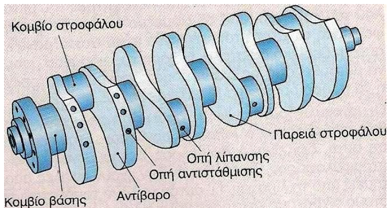
Εικόνα 1.16: Στροφαλοφόρος άξονας με κομβία βάσης και διωστήρων.
