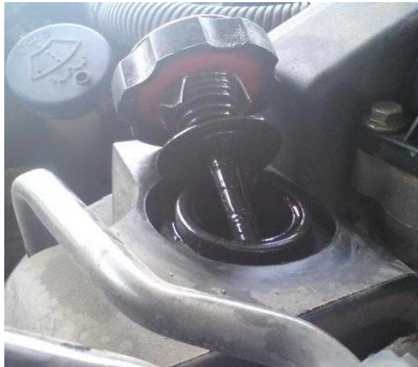
Εικόνα 1.29: Δείκτης έλεγχου στάθμης υγρού σε σύστημα διεύθυνσης υδραυλικής ισχύος.
