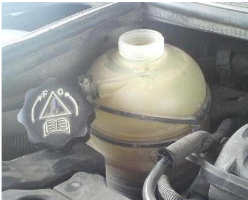
Εικόνα 1.26: Έλεγχος στάθμης συστήματος ψύξης.
