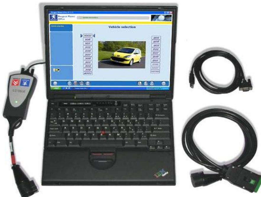
Εικόνα 1.22: Ηλεκτρονικό σύστημα υπολογιστή ανίχνευσης βλαβών.
