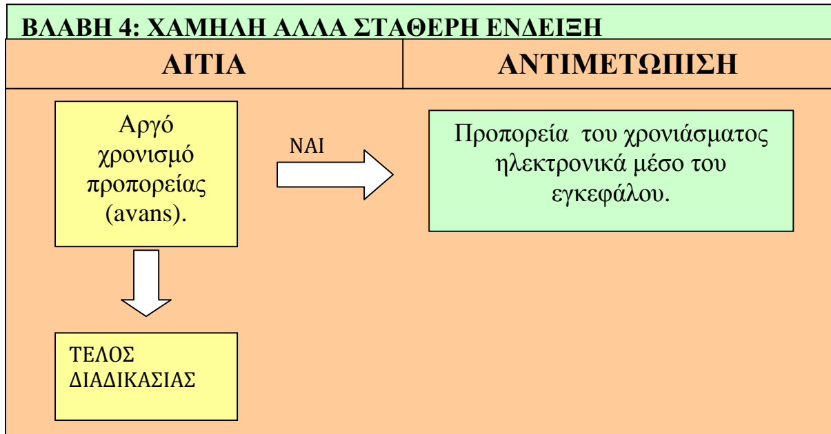
Πίνακας 7: Διάγραμμα ροής εντοπισμού βλάβης χαμηλής σταθερής ένδειξης.
