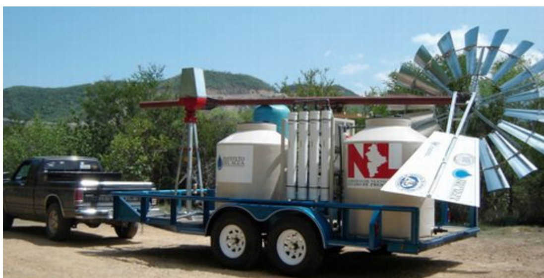
Εικόνα 6.3 Κινητή μονάδα αφαλάτωσης που χρησιμοποιεί αιολική ενέργεια.
