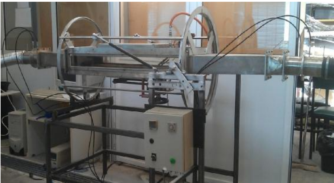
Εικόνα 30: Πειραματική συσκευή για φωτιά σε κρυφές περιοχές.
