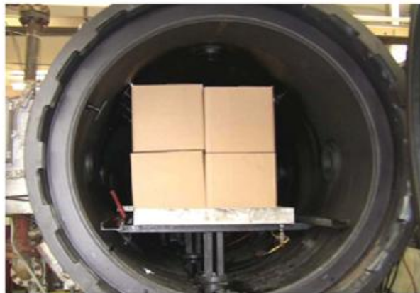
Εικόνα 7: Πειραματική συσκευή - δοχείο πίεσης για την εξέταση της αποτελεσματικότητας της αποσυμπίεσης αεροσκαφών. (Hill, 2010).
