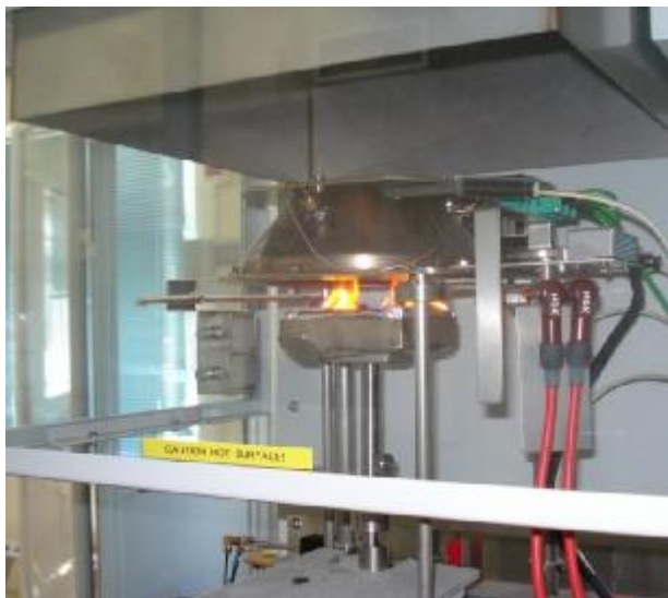
Εικόνα 26: Τυπική εικόνα καύσης δοκιμίου κατά την διαδικασία ελέγχου δοκιμίου ως προς την αντίδρασή του στη φωτιά.
