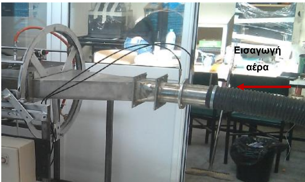
Εικόνα 31: Κανάλι εισαγωγής του αέρα
