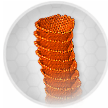
Σχήμα 1.10: Νανοϊνα άνθρακα με δομή ψαροκόκαλο’
