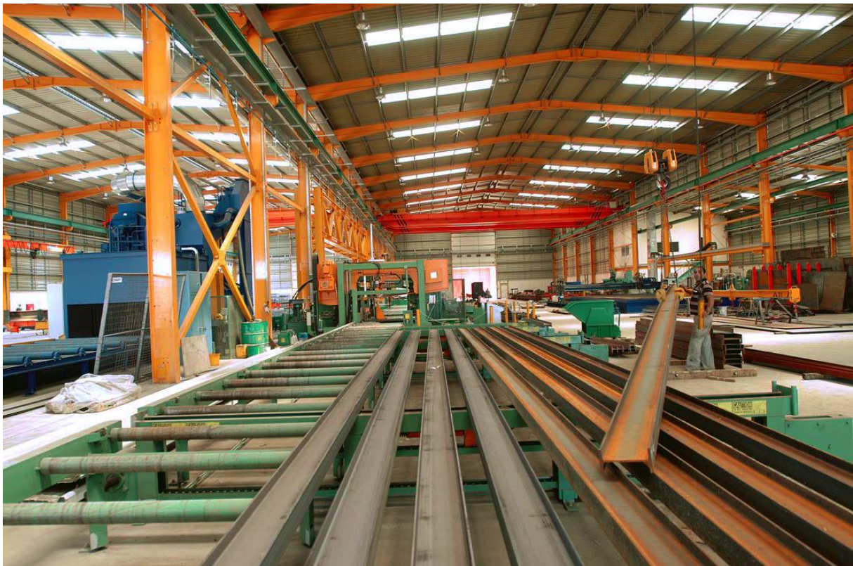
Σχήμα 13. Αυτόματη μεταφορά τμημάτων χάλυβα στα τμήματα παραγωγής
