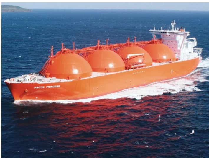
ΕΙΚΟΝΑ 11.1 (ΔΕΞΑΜΕΝΟΠΛΙΟ / TANKER ΜΕΤΑΦΟΡΑΣ ΥΓΡΟΠΟΙΗΜΕΝΟΥ ΦΥΣΙΚΟΥ ΑΕΡΙΟΥ LNG) [61]
