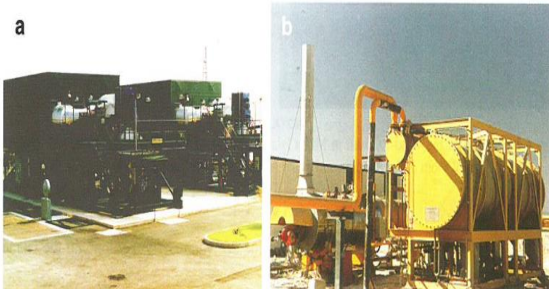
Εικόνα 2.16: Συμβατικές μονάδες συμπίεσης ατμού (MVC στη Σικελία, β) 25 TVC στο Σουέζ.
