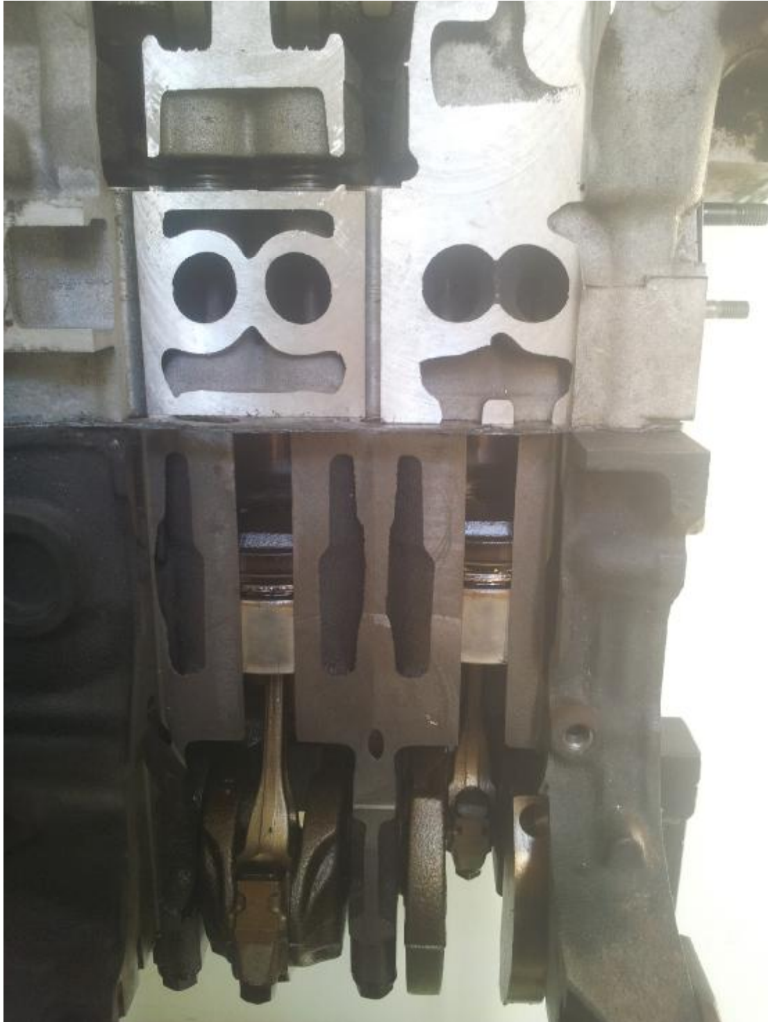
Φωτογραφία της τομής του τέταρτου και τρίτου κυλίνδρου
