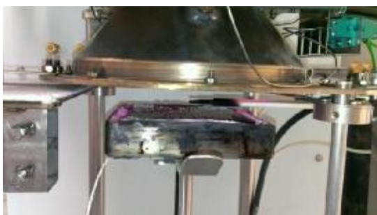
Εικόνα 1. Αρχικό στάδιο έκθεσης δοκιμίου στην πηγή εκπομπής ακτινοβολίας
