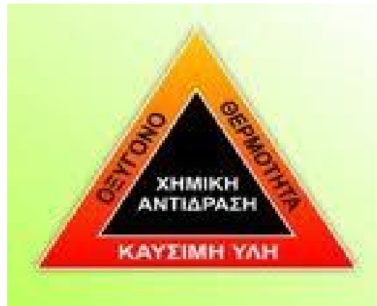
Εικόνα: Στο σχήμα απεικονίζεται το τρίγωνο της φωτιάς και φαίνονται ξεκάθαρα τα τρία στοιχεία του.
