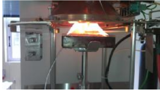
Εικόνα 4. Προχωρημένη καύση δοκιμίου
