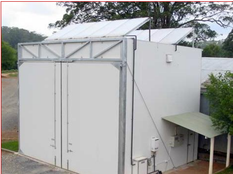
Σχήμα 3.9: Ηλιακό ξηραντήριο τύπου δωματίου με συλλέκτες αέρα.
