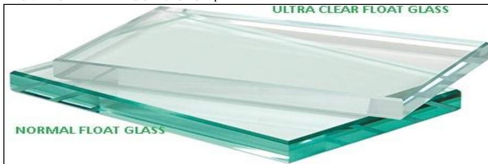
Σχήμα 5.4: Διάφοροι τύποι υαλοπινάκων. Κοινός υαλοπίνακας (κάτω), υαλοπίνακας χαμηλής περιεκτικότητας σε σίδηρο (πάνω). Πηγή: https://www.guardian.com/GuardianGlass
