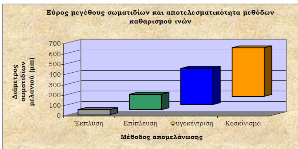
Σχήμα 4.5 Αποτελεσματικότητα των μεθόδων απομελάνωσης ανάλογα με το μέγεθος των σωματιδίων μελανιού [5].
