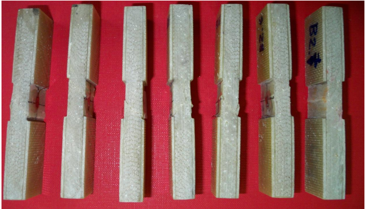
Εικόνα A 14: Θλιπτικά δοκίμια, Ομάδα B2 (όψη C)
