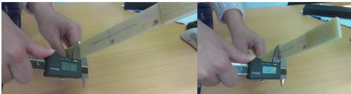
Εικόνα 3.2: Μετρήσεις διαστάσεων διατομής δοκιμίου εφελκυσμού
