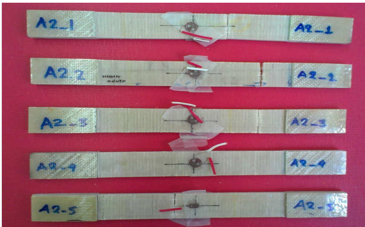
Εικόνα Α 3: Εφελκυστικά δοκίμια, Ομάδα Α2 (όψη Α)
