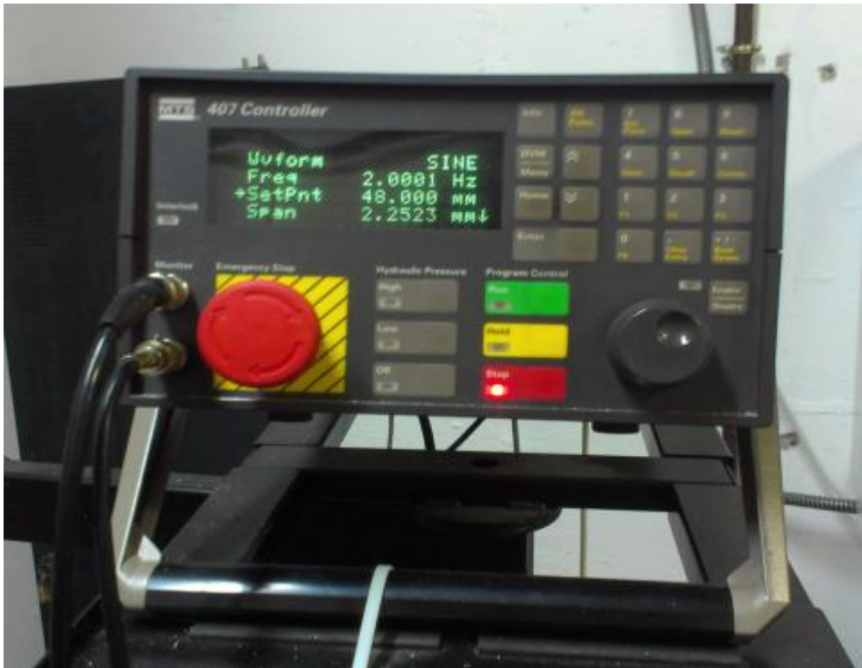
Εικόνα 4.3: Controller MTS 407 της μηχανής δοκιμών
