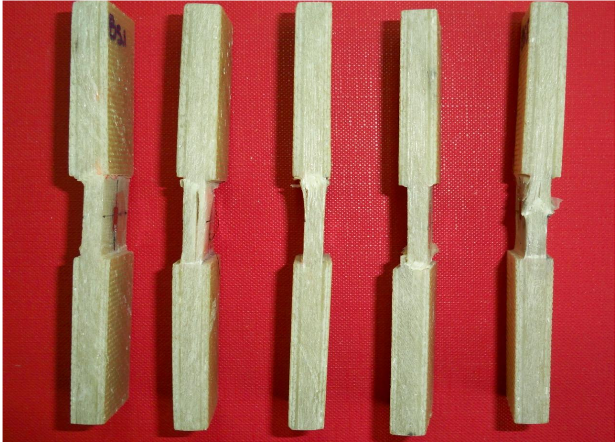
Εικόνα A 19: Θλιπτικά δοκίμια, Ομάδα B5, 1-5 (όψη C)
