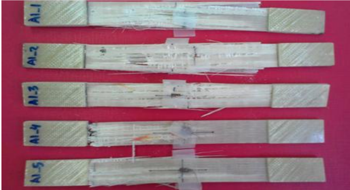
Εικόνα Α.1: Εφελκυστικά δοκίμια, Ομάδα Α1 (όψη Α)
