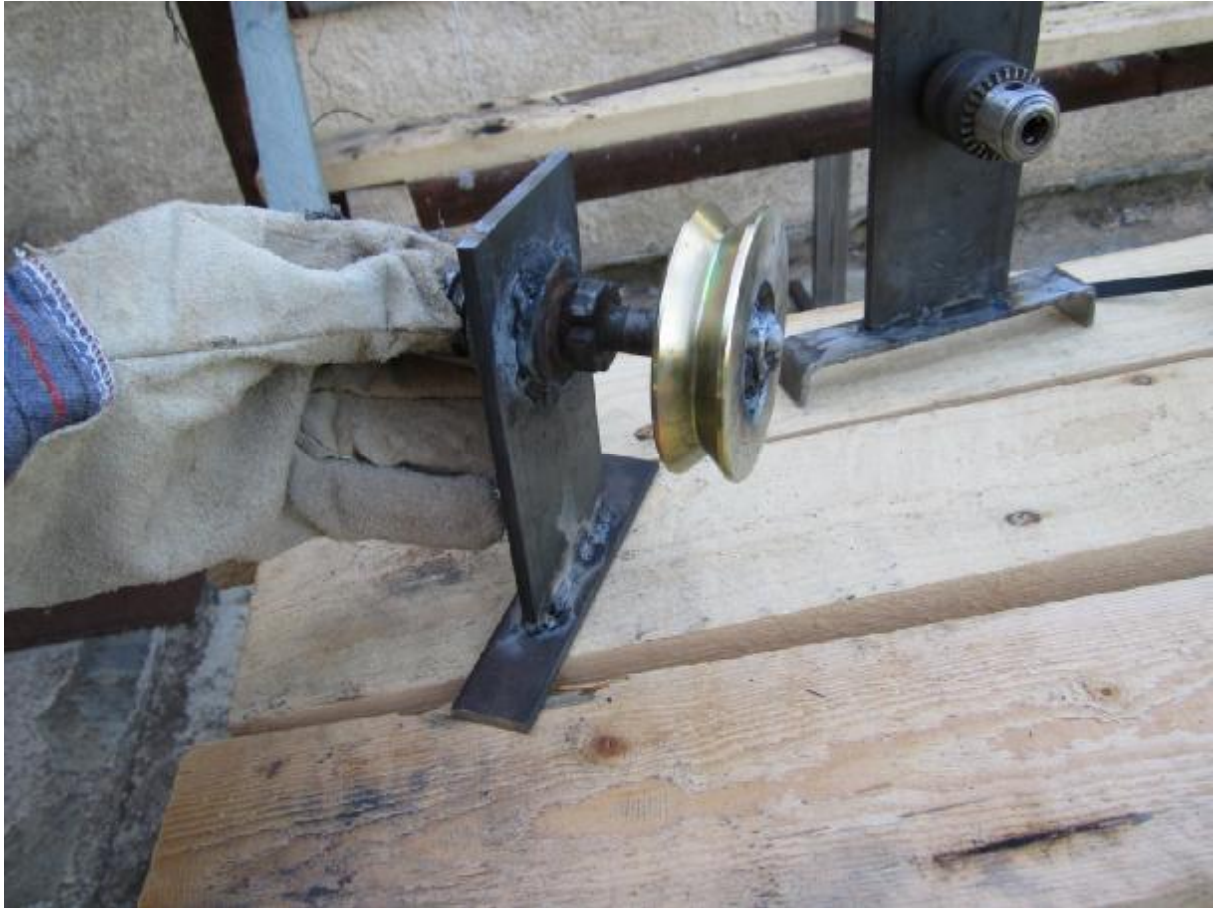
Εικόνα 6.42: Τροχαλία συγκολλημένη στον άξονα του τσοκ
