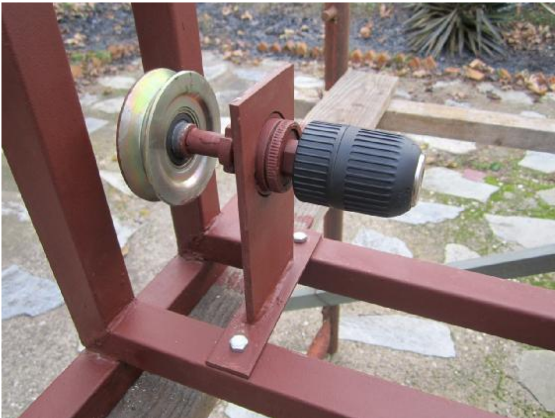
Εικόνα 6.45: Στήριξη περιστρεφόμενου τσοκ στερεωμένη στο πλαίσιο
