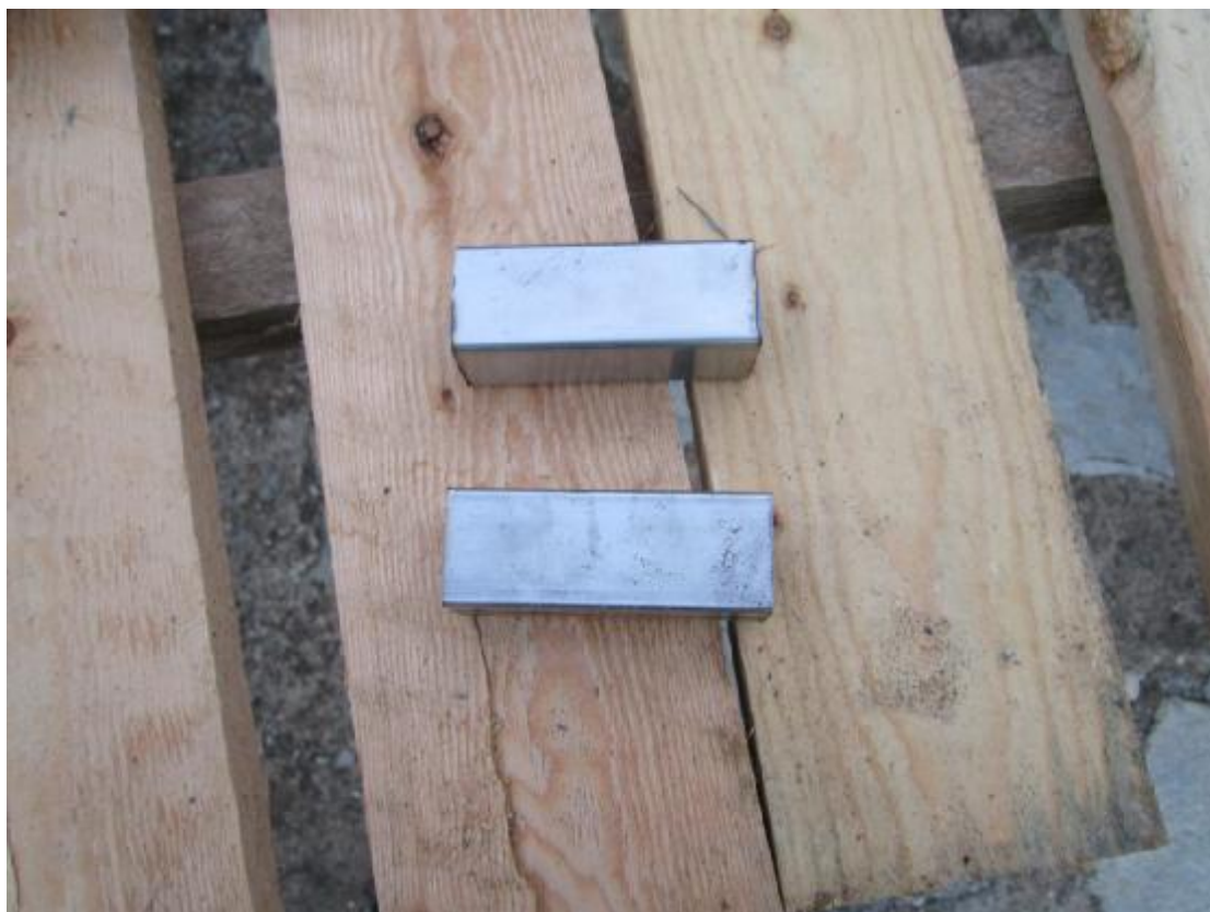
Εικόνα 6.15: Κομμάτια κοιλοδοκών για τις δύο γωνίες του πλαισίου
