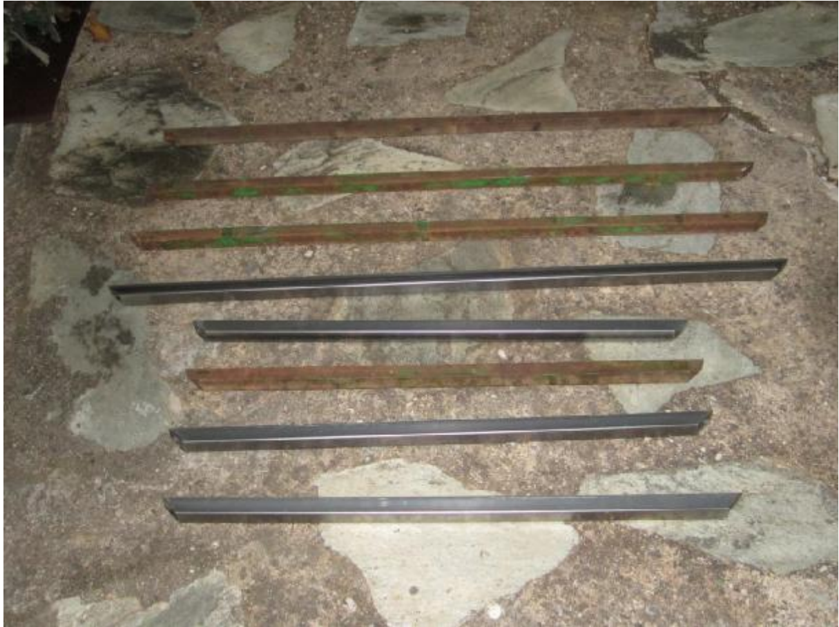
Εικόνα 6.4: Κοιλοδοκοί έτοιμοι για συγκόλληση
