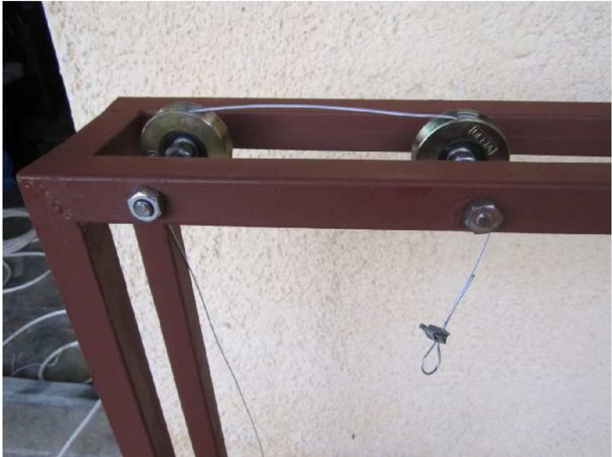
Εικόνα 6.53: Προσθήκη δεύτερης τροχαλίας παρεκλίσεως
