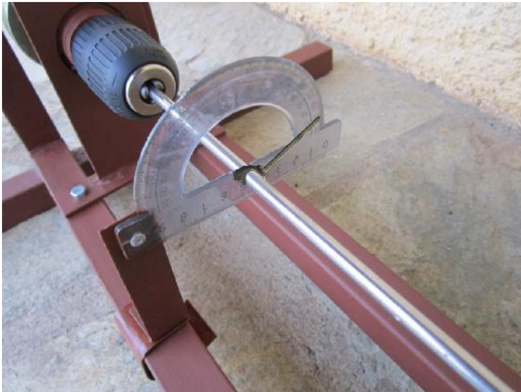
Εικόνα 7.2: Δείκτης σε απόσταση 70cm από το σταθερό τσοκ
