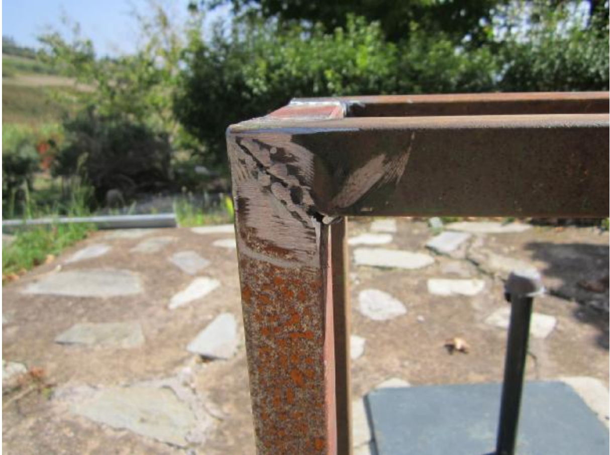
Εικόνα 6.14: Σημεία συγκόλλησης καθαρισμένα με τον τροχό
