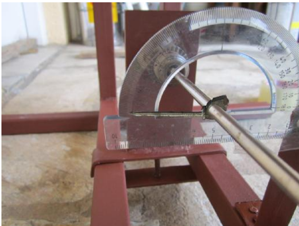
Εικόνα 7.3: Δείκτης σε απόσταση 14cm από το σταθερό τσοκ
