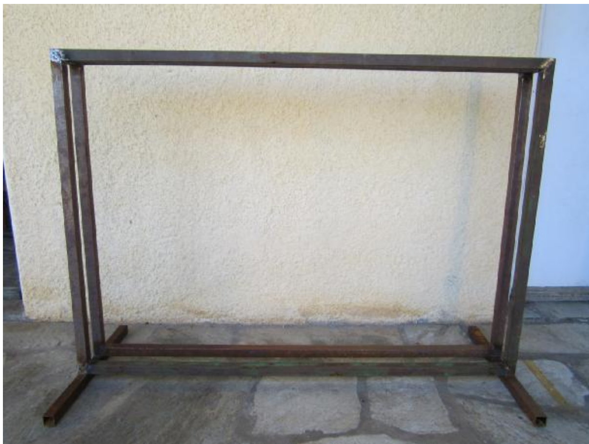
Εικόνα 6.21: Ολοκληρωμένο το πλαίσιο μετά τη συγκόλληση
