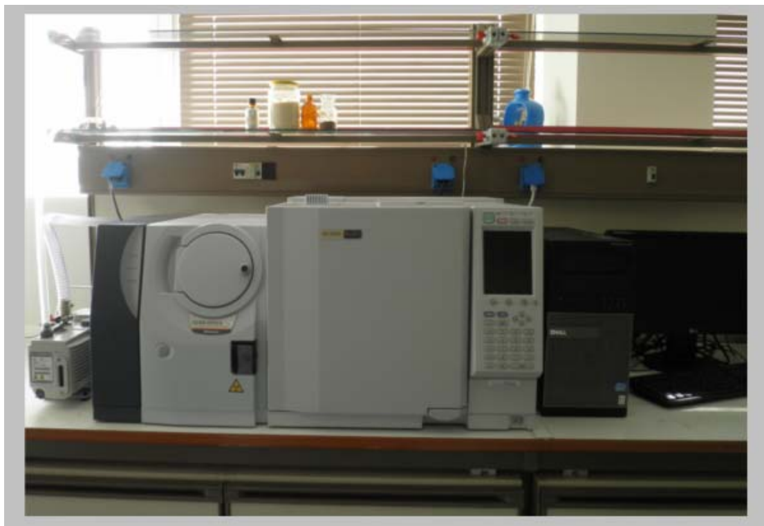
Σχήμα 3.7 Αέριος χρωματογράφος με φασματογράφο μάζας [14].
