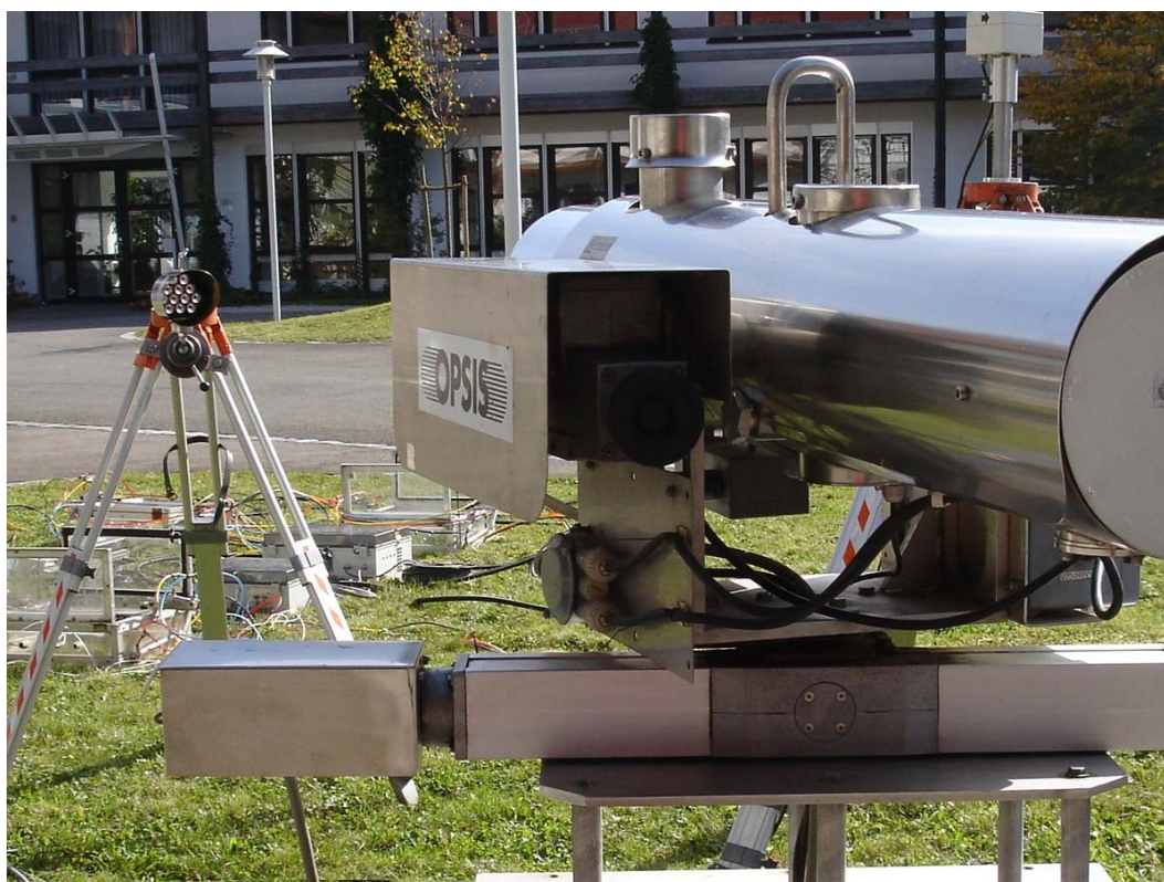
Σχήμα 4.3 Όργανα του συστήματος DOAS. Φαίνεται ο εκπομπός και ο ανακλαστής (πάνω στον τρίποδα) [17].
