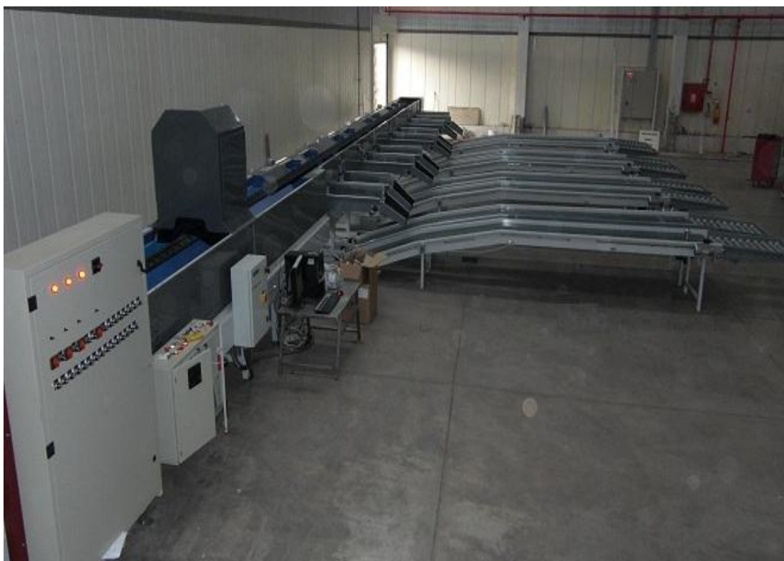
Εικόνα 3.15 Ηλεκτρονικός ταξινομητής εσπεριδοειδών
