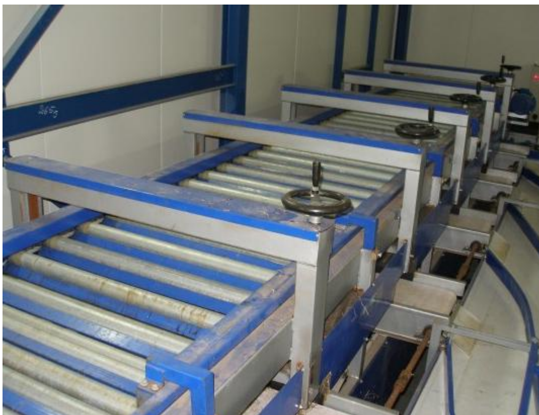
Εικόνα 3.14 Ράουλες μηχανικού ταξινομητή
