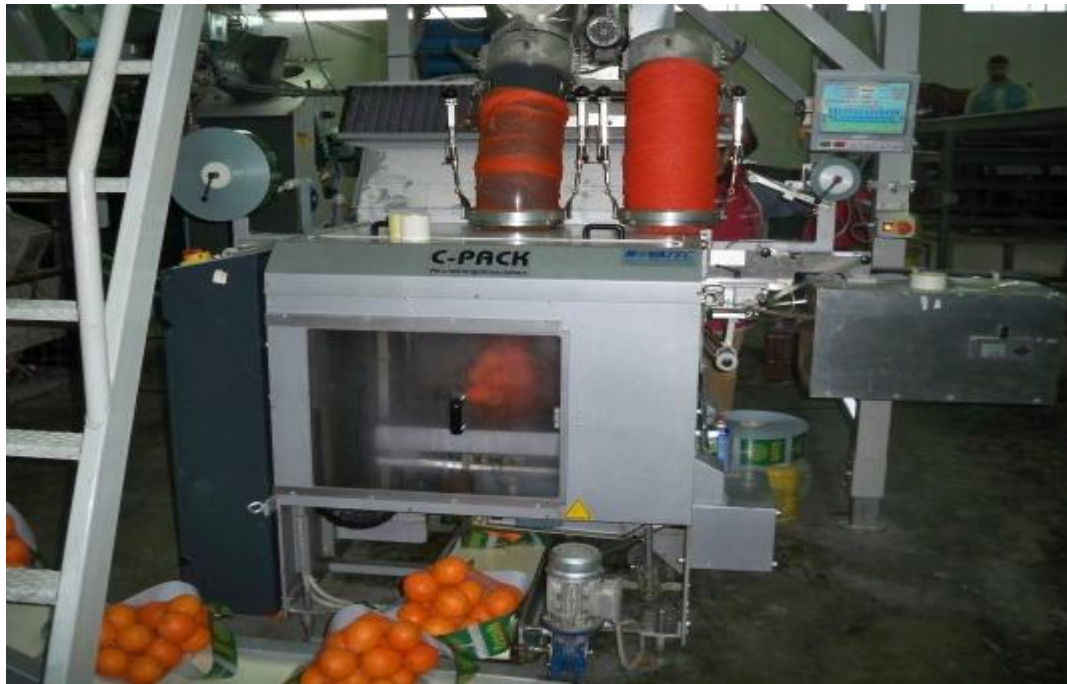
Εικόνα 3.23 Γραμμή συσκευασίας εσπεριδοειδών με κλειστικές μηχανές
