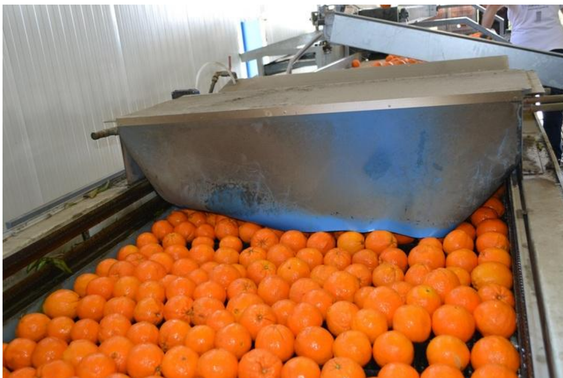
Εικόνα 3.8 Διαδικασία πλυσίματος εσπεριδοειδών
