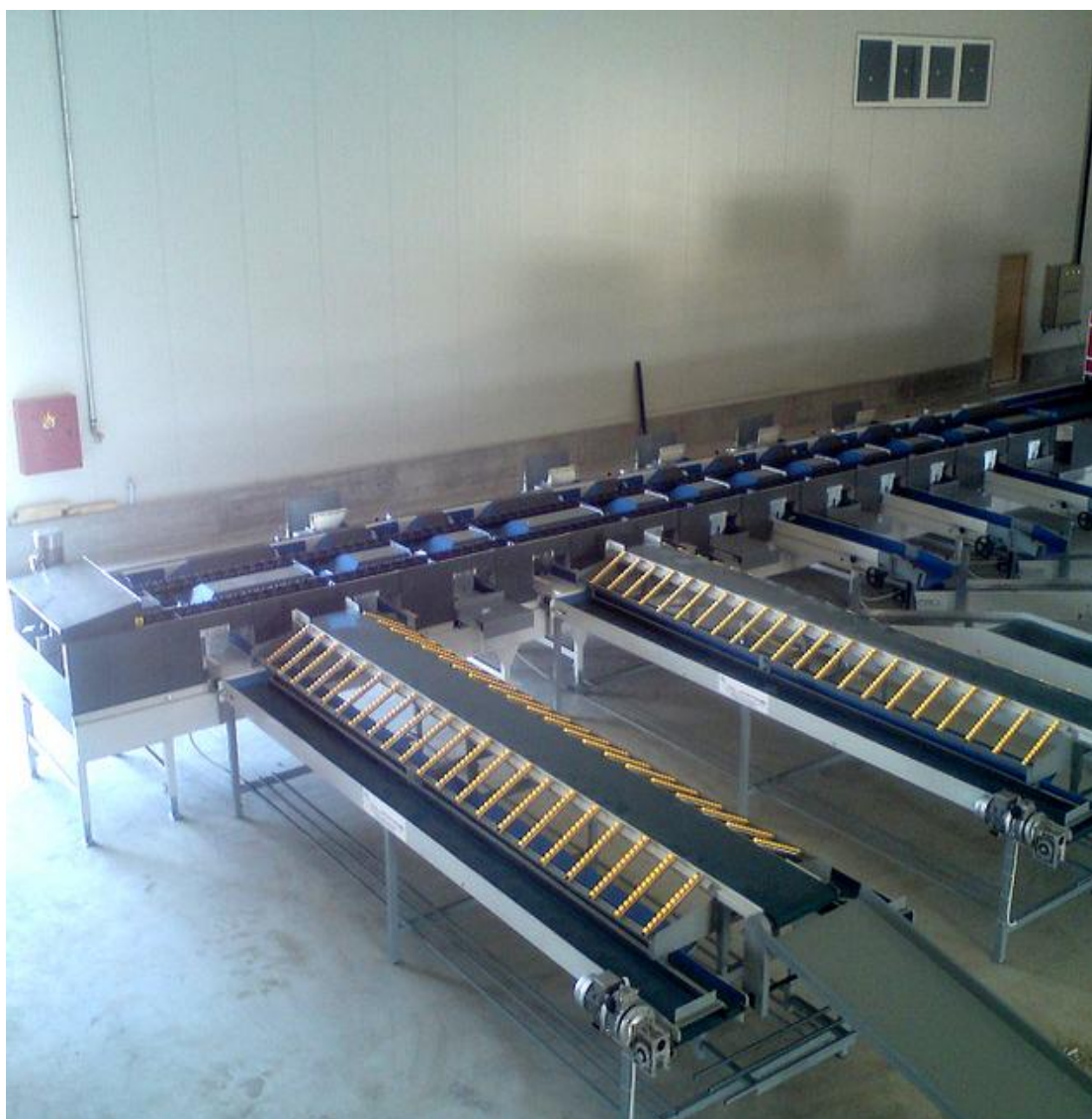
Εικόνα 3.18 Η μέθοδος συσκευασίας των εσπεριδοειδών μέσω των φρουτοθηκών
