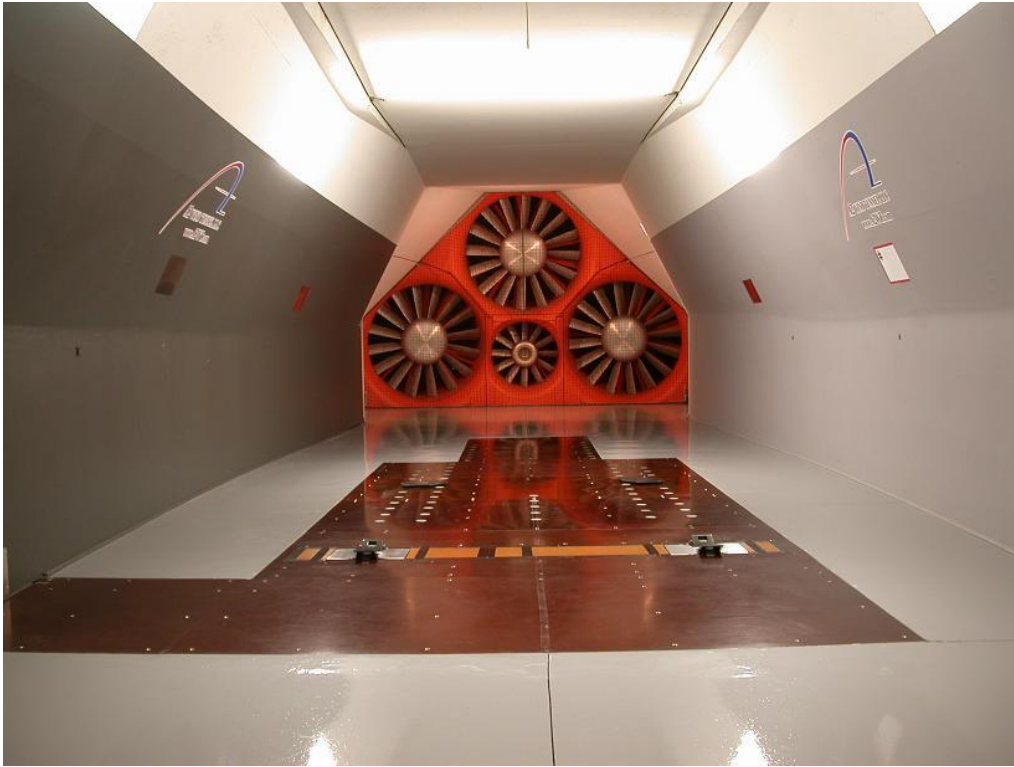
ΕΙΚΟΝΑ 3.1 : Οι ανεμιστήρες το εσωτερικό της αεροσήραγγας A2, στη Βόρεια Καρολίνα (ΠΗΓΗ: www.A2TW.com )
