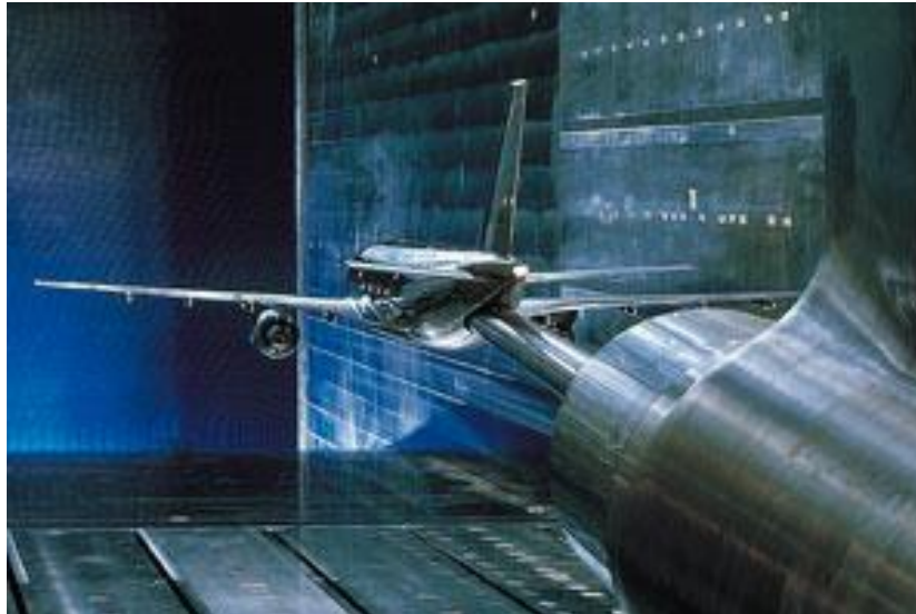
ΕΙΚΟΝΑ 3.6 : Ο χώρος δοκιμών της διηχητικής αεροσήραγγας 8 x 6.5 ft της ETW (ΠΗΓΗ: www.etw.de )
