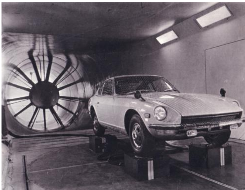
ΕΙΚΟΝΑ 3.2 : Το Datsun Classic 240z, δοκιμάζεται στην αεροσήραγα της Datsun το 1970 (ΠΗΓΗ: www.goodoldvalves.tumblr.com )
