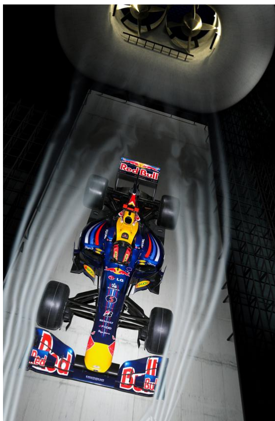
ΕΙΚΟΝΑ 3.3 : Το μονοθέσιο της Red Bull Racing RB10, δοκιμάζεται στην αεροσήραγα της Red Bull Racing το 2009 (ΠΗΓΗ: www.debutart.com )
