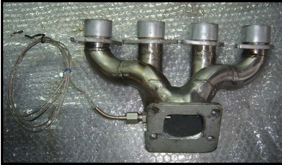
Πλάγια όψη της πολλαπλής με τη φλάντζα σύνδεσης στον υπερσυμπιεστή: Εικόνα 28
