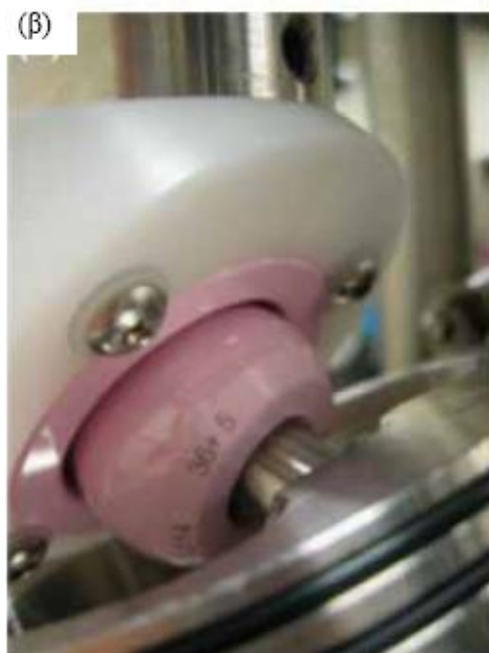
Σχήμα 6.2: (α) Άποψη τεσσάρων σταθμών από προσομοιωτές ισχιακού συνδέσμου με την κεφαλή στην ανατομική θέση. (β) Μοντέλο από κεραμική αλούμινα σε τέστ φθοράς. (γ) Προσομοιωτής γονάτου με μηριαίο στέλεχος από χρωμοκοβάλτιο και κνημιαία πλάκα από πολυαιθυλένιο υψηλού μοριακού
