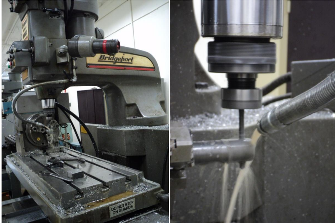
Εικόνα 114: Διάνοξη οπών 6,5mm σε ημιαυτόματη φρέζα του εργαστηρίου c.n.c του Τ.Ε.Ι Πατρών για τοποθέτηση ασφάλειας.
