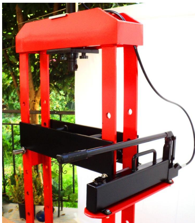
Εικόνα 136: Τοποθέτηση της αντλίας σε εργονομική θέση πάνω στο πλαίσιο.
