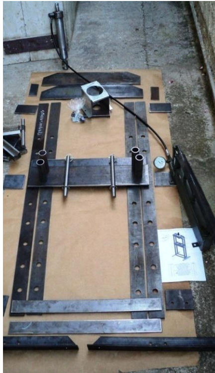
Εικόνα 116: Συγκέντρωση στοιχείων υδραυλικής πρέσας και έλεγχος των διαστάσεων τους σύμφωνα με τα σχέδια.
