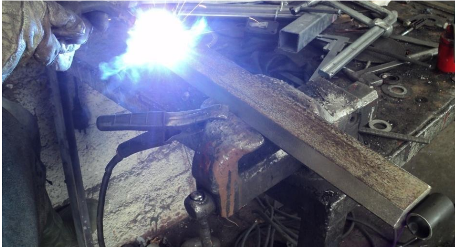
Εικόνα 130: Συγκόλληση δακτυλίων ολίσθησης στα άκρα του εμβόλου.
