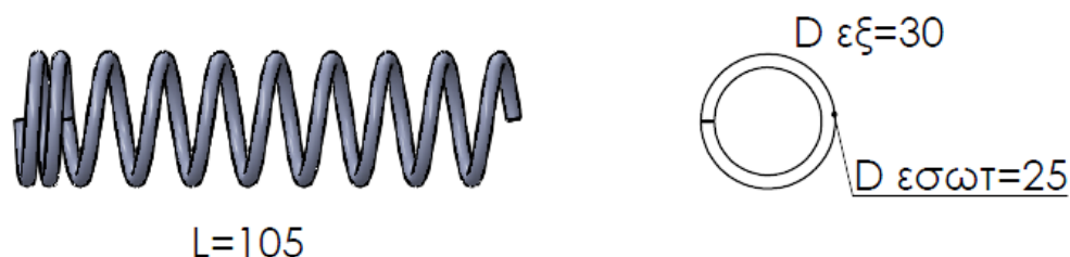
Εικόνα 76: Σχεδιασμός τεμαχίου No 6. Ελατήριο επαναφοράς εμβόλου.
