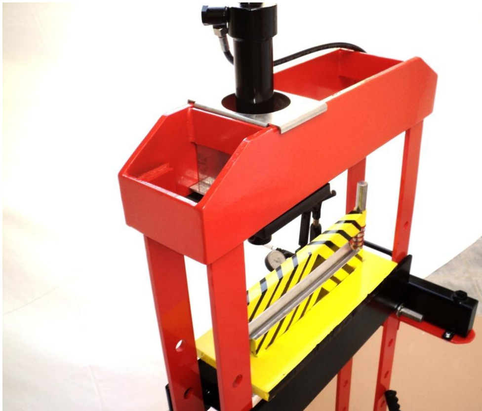
Εικόνα 140: Χρησιμότητα λαμών-στοπ στο μέσα μέρος της κεφαλής της πρέσας.
