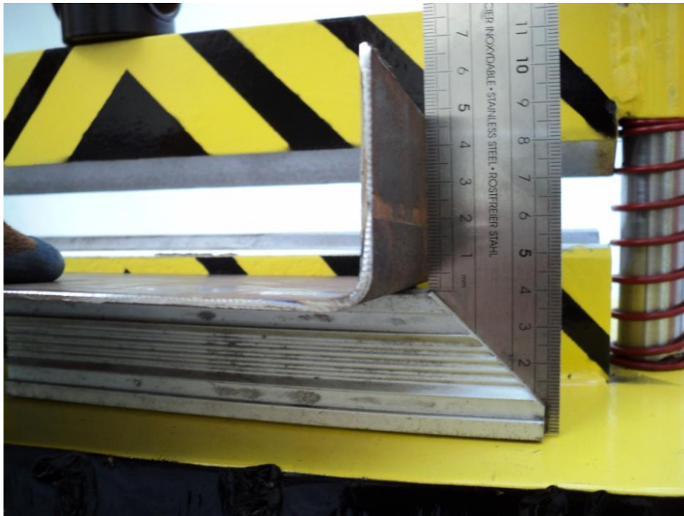
Εικόνα 145: Μέτρηση γωνίας κάμψης λαμαρίνας πάχους 3mm.
