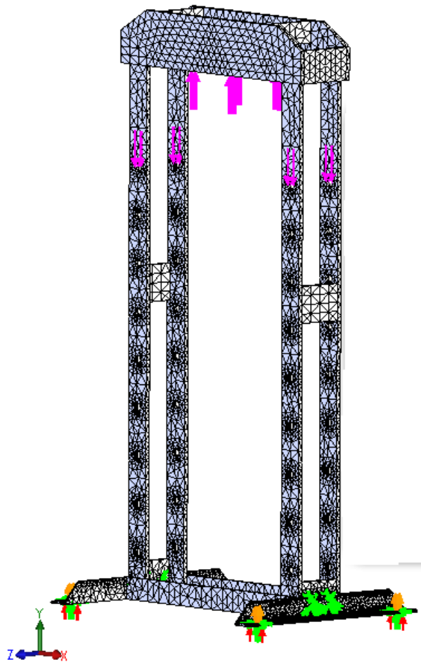
Εικόνα 82: Κάναβος πεπερασμένων στοιχείων πλαισίου πρέσας.
