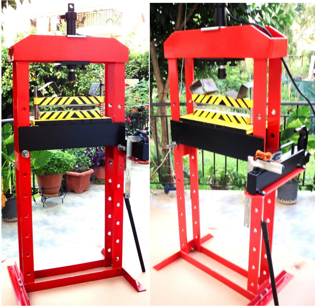
Εικόνα 147: Επιδαπέδια υδραυλική πρέσα δυναμικότητας 10 τόνων με μηχανισμό κινούμενου υδραυλικού κυλίνδρου και δυνατότητα κάμψης λαμαρίνας υπό γωνία 90 μοιρών.
