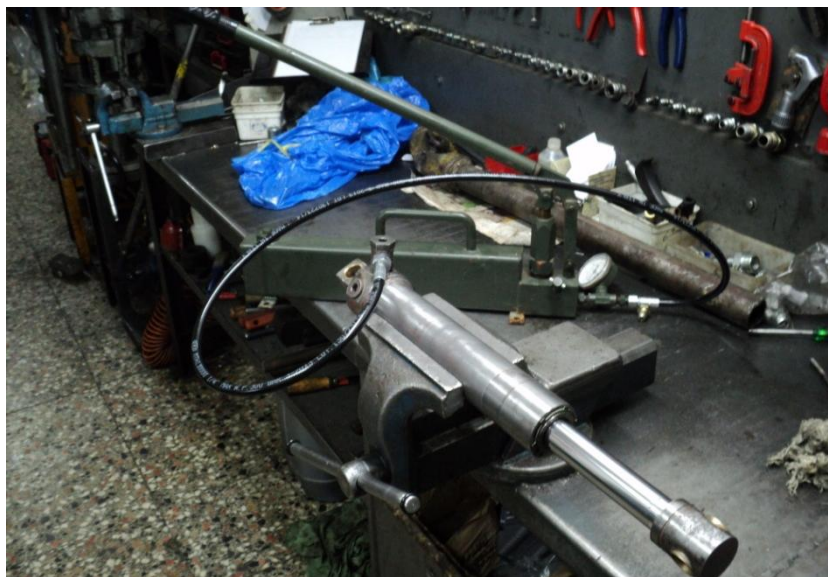
Εικόνα 108: Σύνδεση αντλίας/κυλίνδρου με υδραυλικό μαρκούτσι πίεσης 300 bar.
