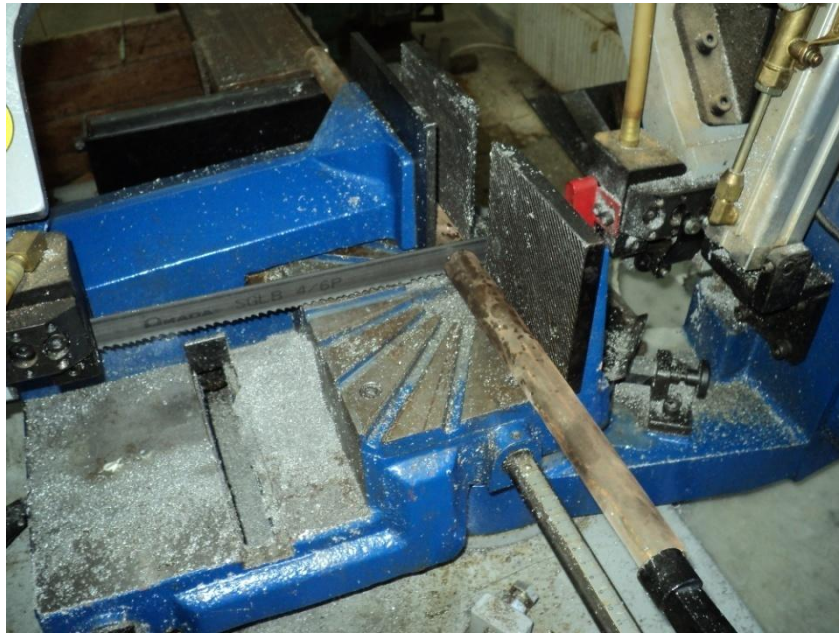
Εικόνα 112: Κοπή ράβδου χάλυβα για την κατασκευή πείρων συγκράτησης τραπεζιού πρέσας σε πριόνι του Τ.Ε.Ι Πατρών.
