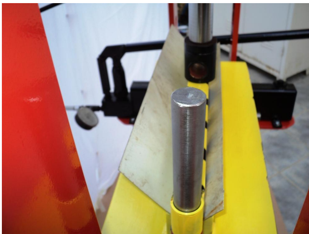
Εικόνα 142: Δοκιμή καλουπιού κάμψης σε φύλλο λαμαρίνας πάχους 0,5 mm.
