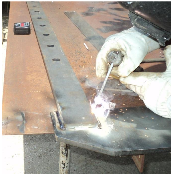
Εικόνα 121: Συγκόλληση στοιχείων κάθετων λαμών στην κεφαλή της πρέσας.
