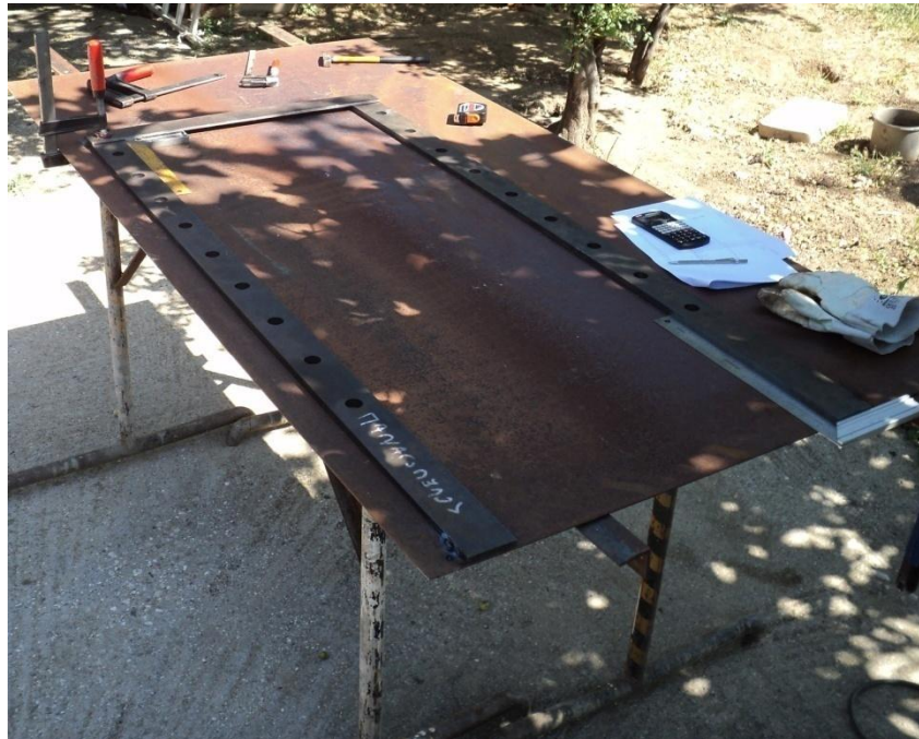
Εικόνα 117: Γώνιασμα και μοντάρισμα πρόσοψης πλαισίου πρέσας.
