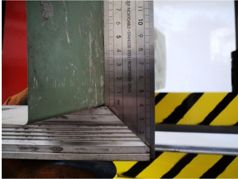
Εικόνα 143: Μέτρηση γωνίας κάμψης φύλλου λαμαρίνας πάχους 0,5mm.
