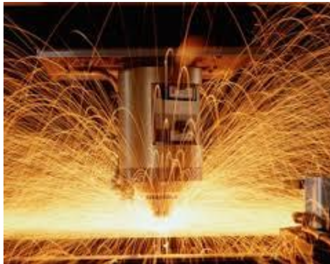
Εικόνα 109: Διάνοιξη οπών σε Φύλλο χάλυβα πάχους 12 mm.
