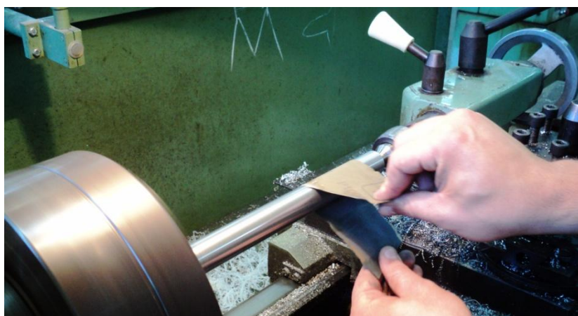
Εικόνα 128: Κατασκευή πείρων οδήγησης σε συμβατικό τόρνο.
