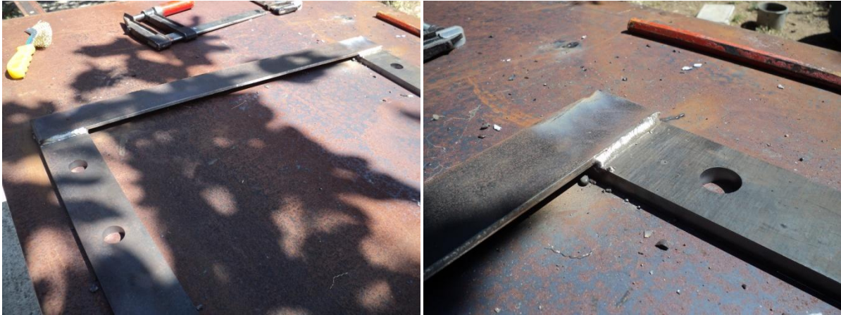
Εικόνα 118: Συγκόλληση κάτω λάμας-αποστάτη πρόσοψης πλαισίου πρέσας.
