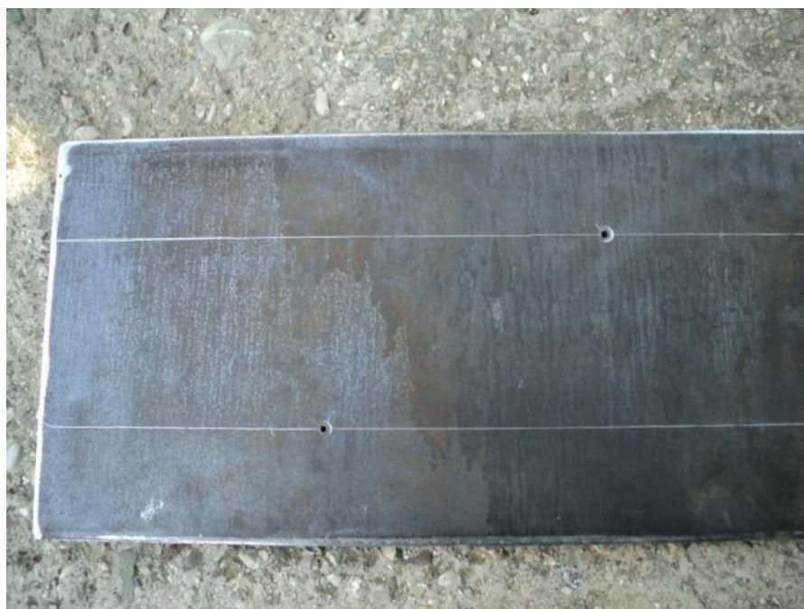
Εικόνα 124: Διάνοιξη οπών στην λάμα του τραπεζιού της πρέσας.
