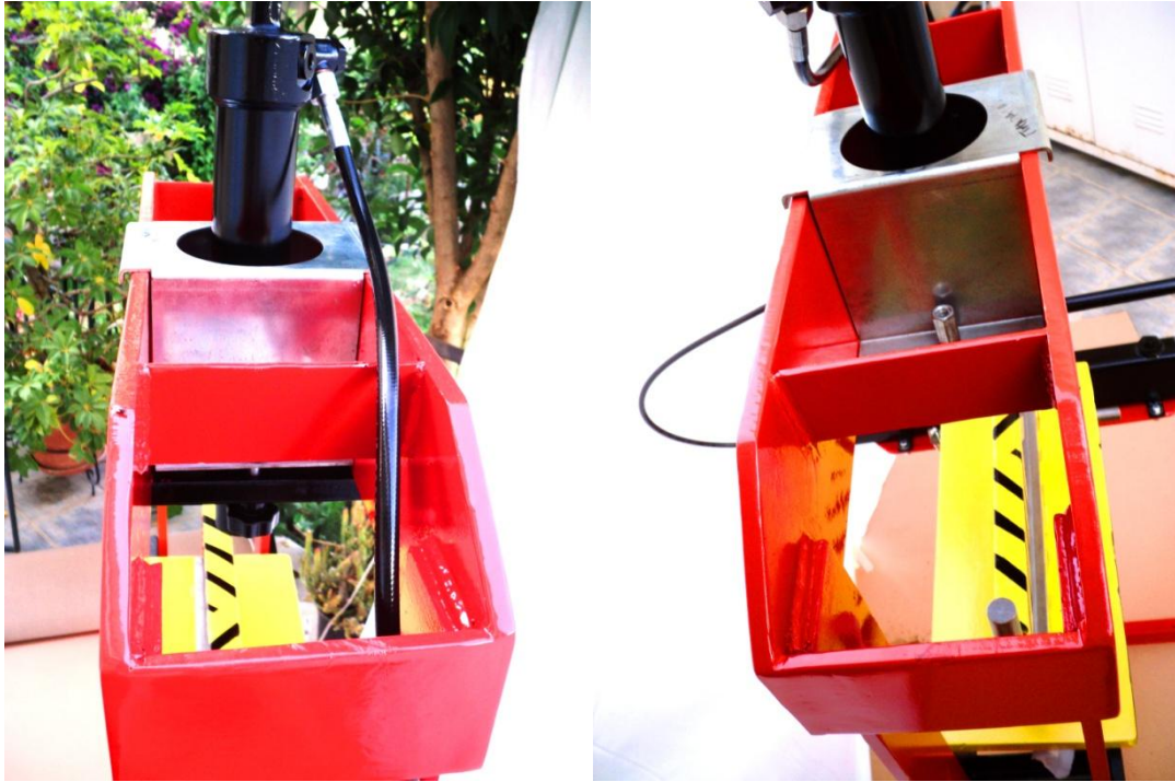
Εικόνα 139: Μηχανισμός κινούμενου υδραυλικού κυλίνδρου εντός της κεφαλής της πρέσας.
