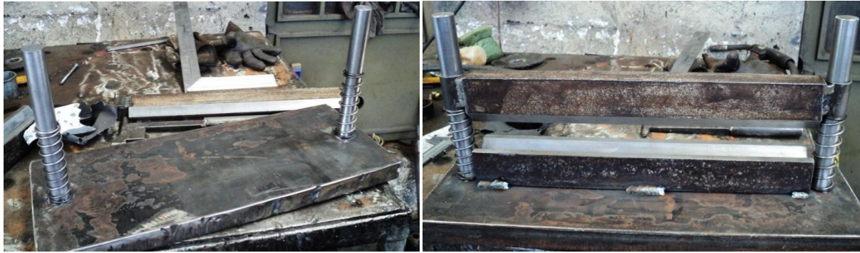
Εικόνα 132: Συγκόλληση μήτρας στην πλάκα στήριξης του καλουπιού και τοποθέτηση ελατηρίων.
