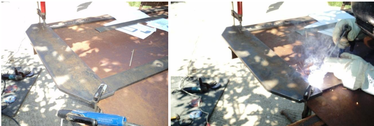
Εικόνα 119: Μοντάρισμα και συγκόλληση κεφαλής πρέσας.
