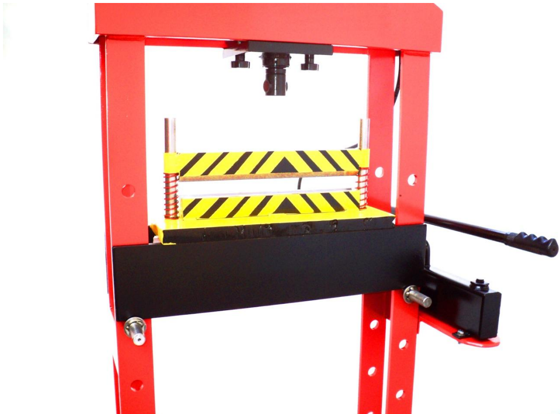
Εικόνα 137 : Τοποθέτηση καλουπιού κάμψης στο τραπέζι της πρέσας.
