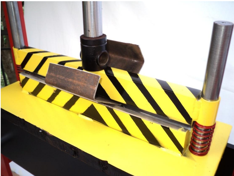
Εικόνα 146: Δημιουργία τεμαχίου με την χρήση του καλουπιού κάμψης.
