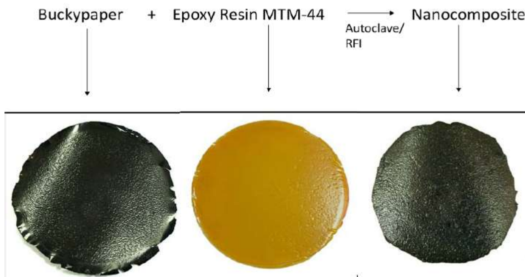
Σχήμα 1.5: Φωτογραφίες μεμβράνης νανοσωλήνων άνθρακα πολλαπλού τοιχίου(αριστερά), σκέτης εποξικής ρητίνης (μέση) και νανοσύνθετου (δεξιά)
