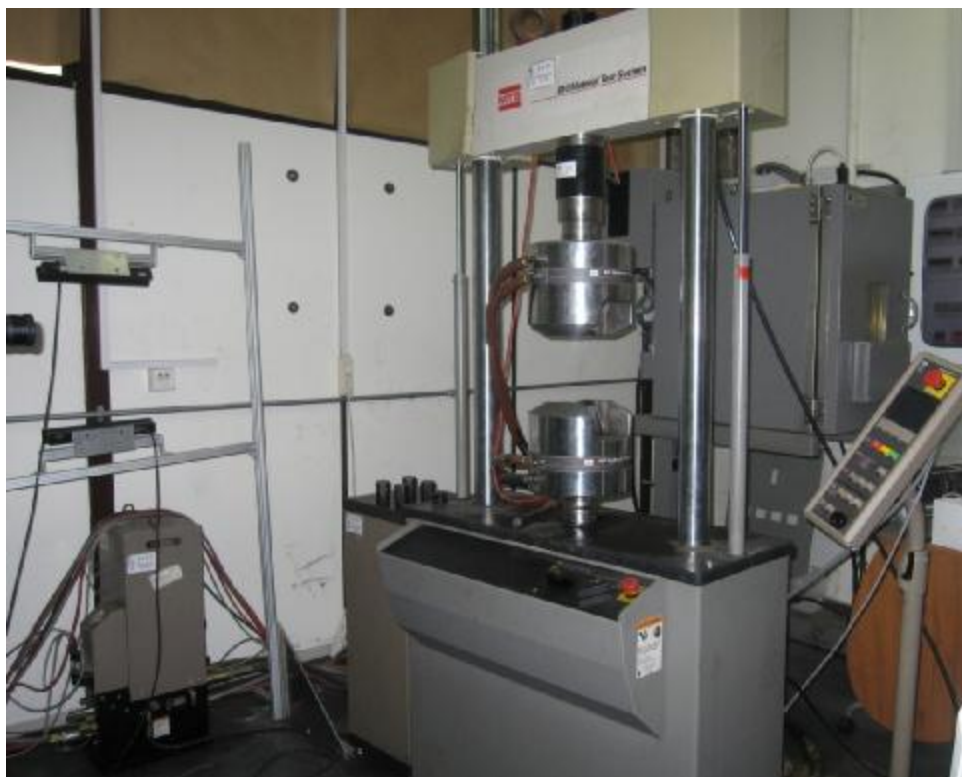
Σχήμα 53: Μηχανή γενικών δοκιμών MTS
