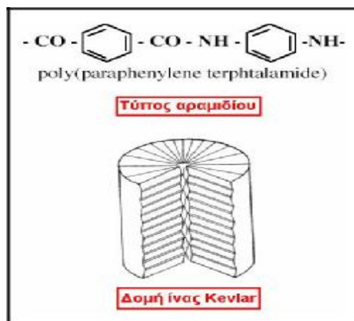
Σχήμα 17 : Δομή ίνας Kevlar
