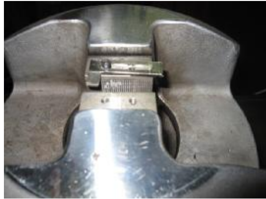
Σχήμα 54: Τοποθέτηση δοκιμίου στη μηχανή Σχήμα 55: Οδηγός ευθυγράμμισης
