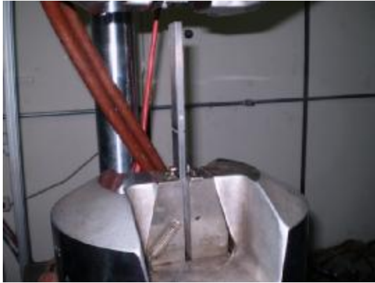
Σχήμα 54: Τοποθέτηση δοκιμίου στη μηχανή Σχήμα 55: Οδηγός ευθυγράμμισης
