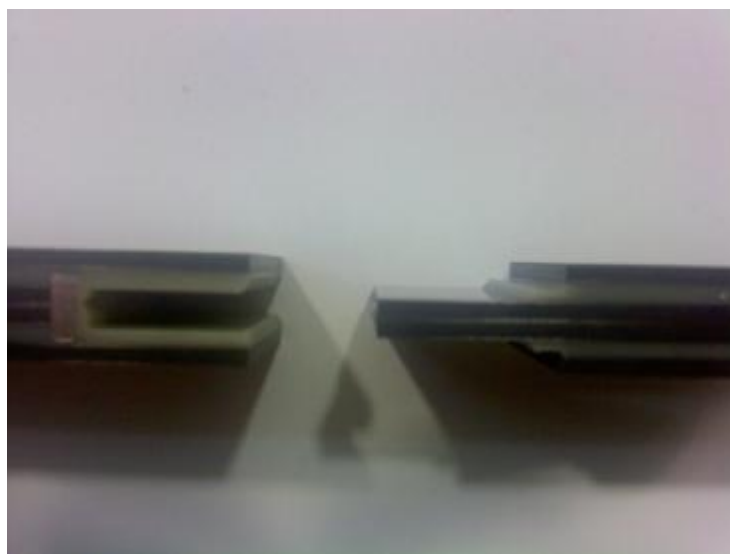
Σχήμα 59: Επιφάνεια θραύσης μετά τη διαμητική αστοχία
