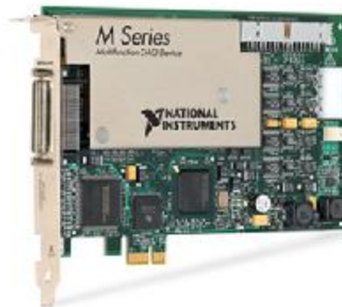
Εικόνα 25. α: Κάρτα DAQ που τοποθετείται στον δίαυλο PCI ( http://www.ni.com )
