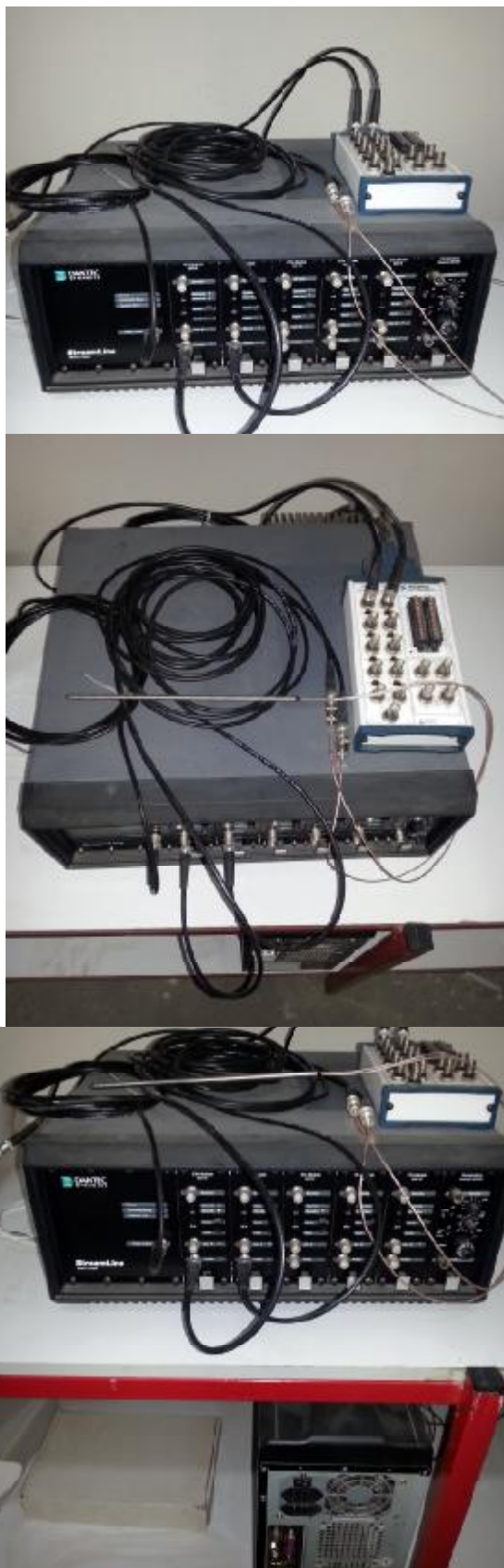
Εικόνα 30: Βασική μονάδα Ανεμομετρία Θερμού Σύρματος
