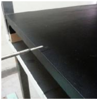
Εικόνα 35: Αισθητήρας ανεμομετρίας μονού θερμού σύρματος, τοποθετημένος στην έξοδο του καναλιού, για τη μέτρηση του οριακού στρώματος
