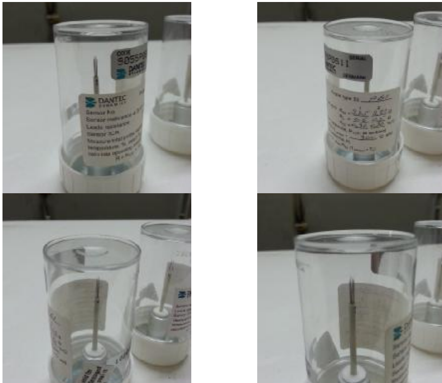
Εικόνα 32: Αισθητήρες θερμού σύρματος τύπου X, για τη μέτρηση δισδιάστατου πεδίου ροής
