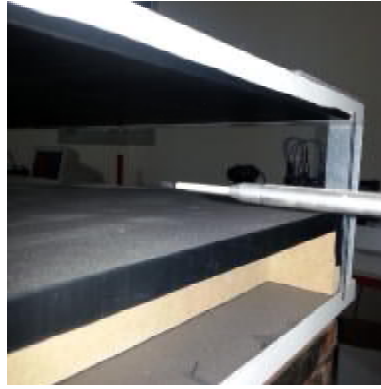
Εικόνα 34: Αισθητήρας ανεμομετρίας θερμού σύρματος τύπου X, τοποθετημένος στην έξοδο του καναλιού, για τη μέτρηση του δισδιάστατου πεδίου ταχύτητας
