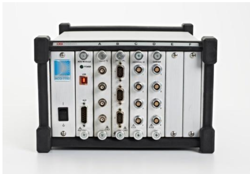
Εικόνα 28. Άποψη signal conditioner ( http://www.ni.com ).
