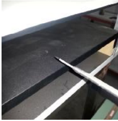
Εικόνα 34: Αισθητήρας ανεμομετρίας θερμού σύρματος τύπου X, τοποθετημένος στην έξοδο του καναλιού, για τη μέτρηση του δισδιάστατου πεδίου ταχύτητας
