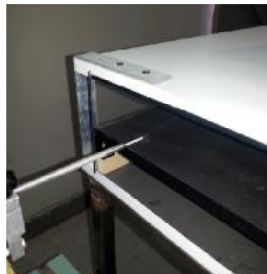
Εικόνα 33: Μηχανισμοί στήριξης και μετακίνησης των αισθητηρίων μέτρησης
