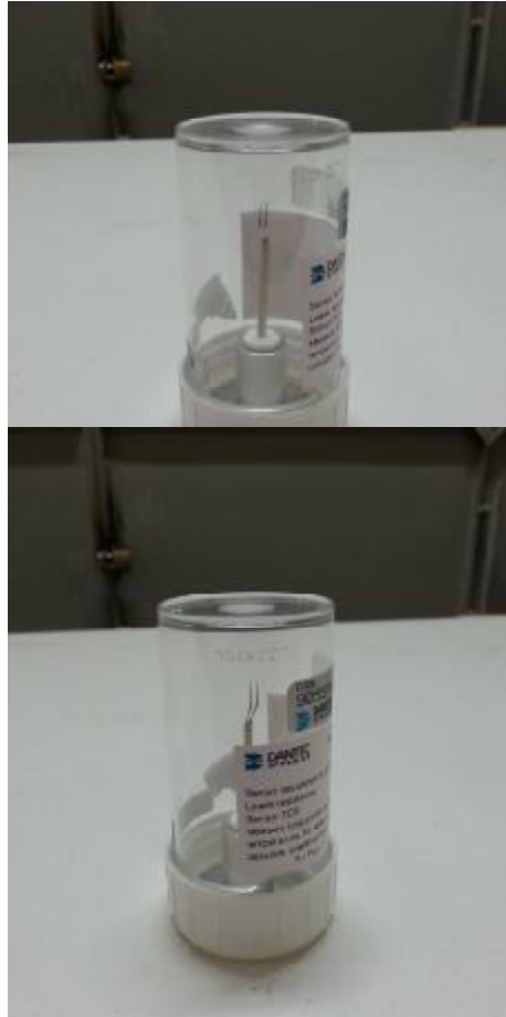
Εικόνα 31: Αισθητήρες θερμού σύρματος, για τη μέτρηση οριακού στρώματος
