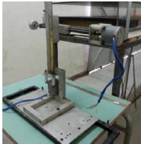
Εικόνα 33: Μηχανισμοί στήριξης και μετακίνησης των αισθητηρίων μέτρησης
