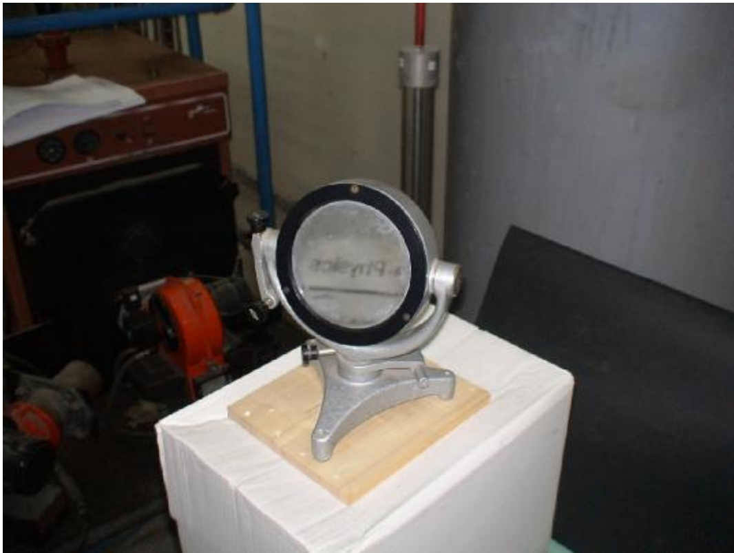
Εικόνα 4.19.: Καθρέπτης για την κατεύθυνση της δέσμης
