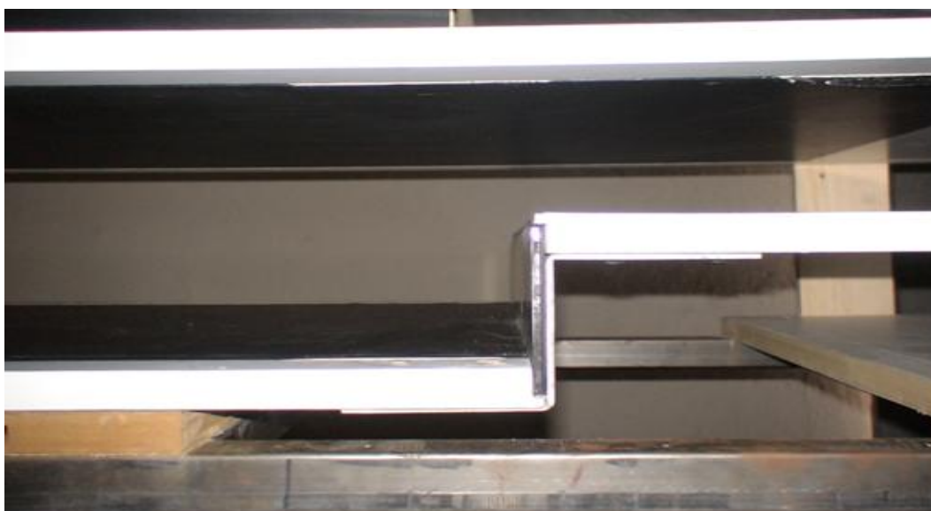
Εικόνα 4.4.: Πλάγια όψη καναλιού (λεπτομέρεια σκαλοπατιού).
