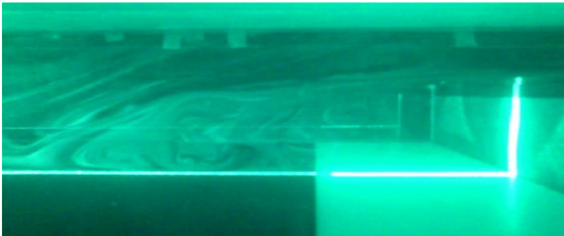
Εικόνα 5.21.: Στιγμιότυπα μετάβασης από στρωτό σε ασταθές πεδίο (vii).
