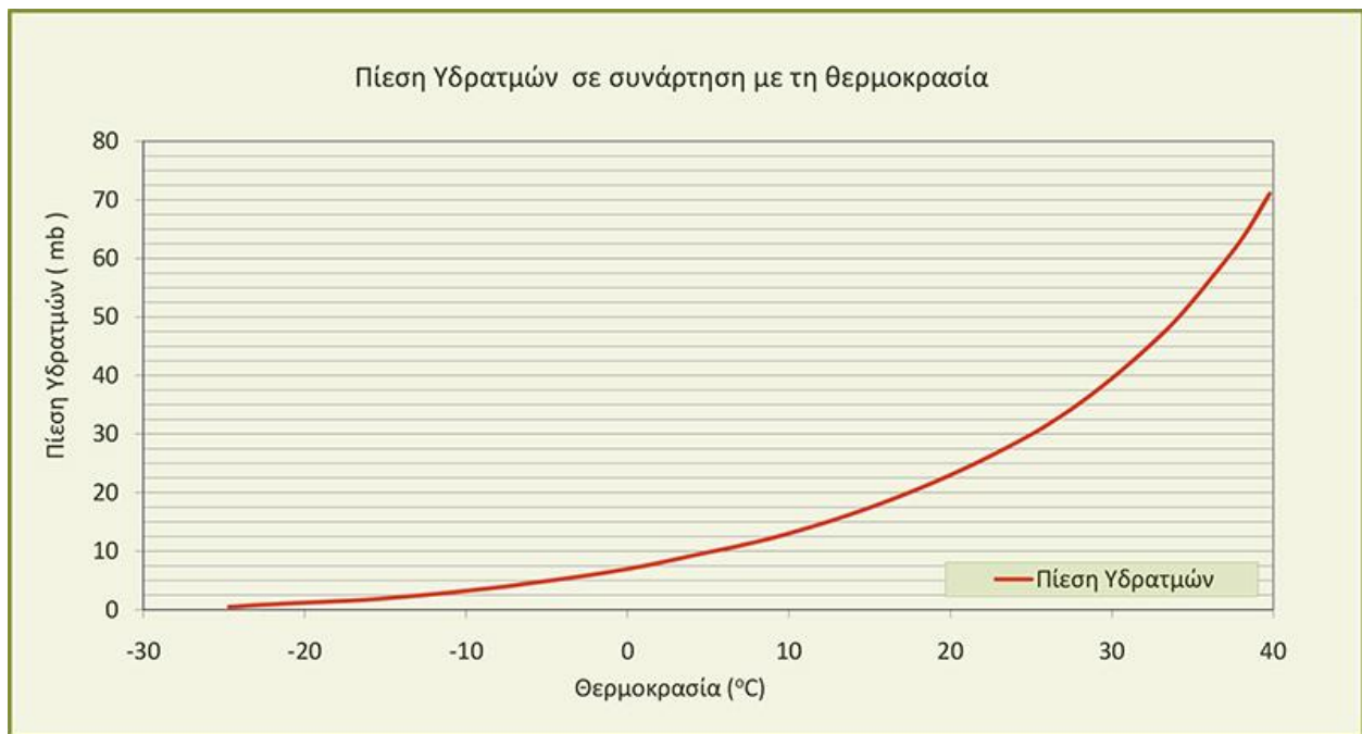
Εικόνα 1.1: Πίεση υδρατμών σε συνάρτηση με την θερμοκρασία του νερού.
