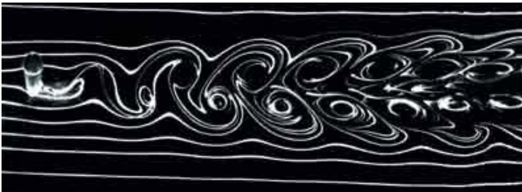
Εικόνα 3.4: Οι σειρές του Von Karman που σχηματίζονται πίσω από ένα κύλινδρο [3].
