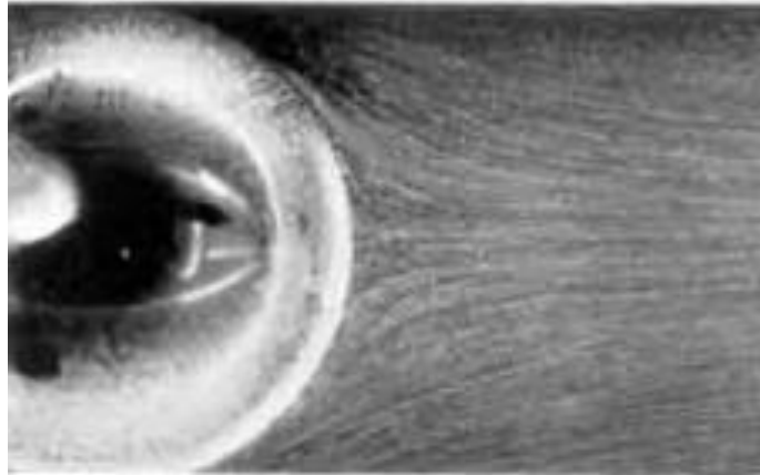
Εικόνα 3.7: Ροή πίσω από σφαίρα για Re=17.9 [6].
