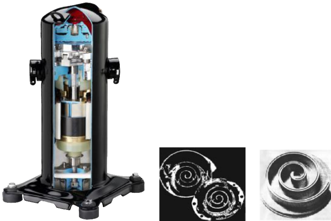
Σχήμα 2.5: Τομή του σπειροειδούς συμπιεστή και σπειροειδή στοιχεία αντίστοιχου συμπιεστή.
