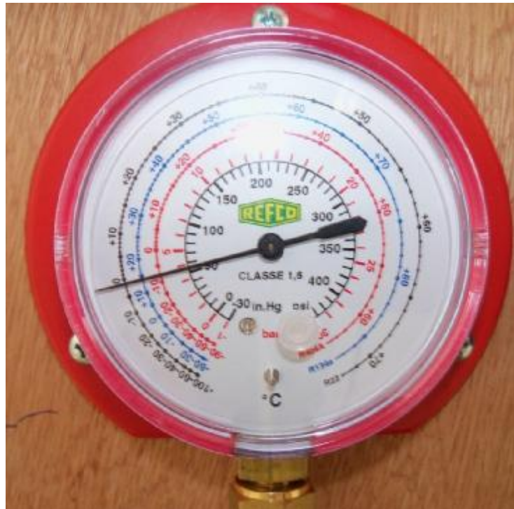
Εικόνα 2.9: Μανόμετρο υψηλής πίεσης, για ένδειξη της πίεσης στο κομμάτι με την υψηλή πίεση (συμπιεστής-συμπυκνωτής).
