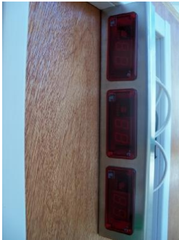
Εικόνα 2.8: Ψηφιακό όργανο Dixell XR-20 με αισθητήρα, το οποίο υπάρχει 3 φορές για ένδειξη της θερμοκρασίας σε διαφορετικά σημεία, μία ένδειξη μετά τον συμπιεστή, μία ένδειξη μετά τον συμπυκνωτή και μία ένδειξη μετά τον εξατμιστή.
