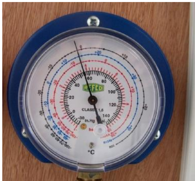
Εικόνα 2.10: Μανόμετρο χαμηλής πίεσης, για ένδειξη στο κομμάτι της χαμηλής πίεσης (εκτονωτική διάταξη-εξατμιστής).
