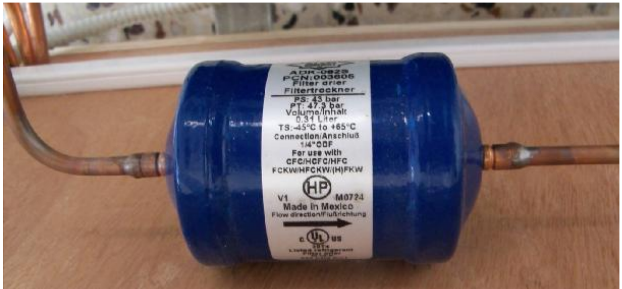
Εικόνα 2.13: Φίλτρο ¼ Alco κολλητή, για κατακράτηση τυχόν ξένων σωματιδίων στο ρευστό. Εδώ πρέπει να τονιστεί ότι το φίλτρο έχει συγκεκριμένη φορά.
